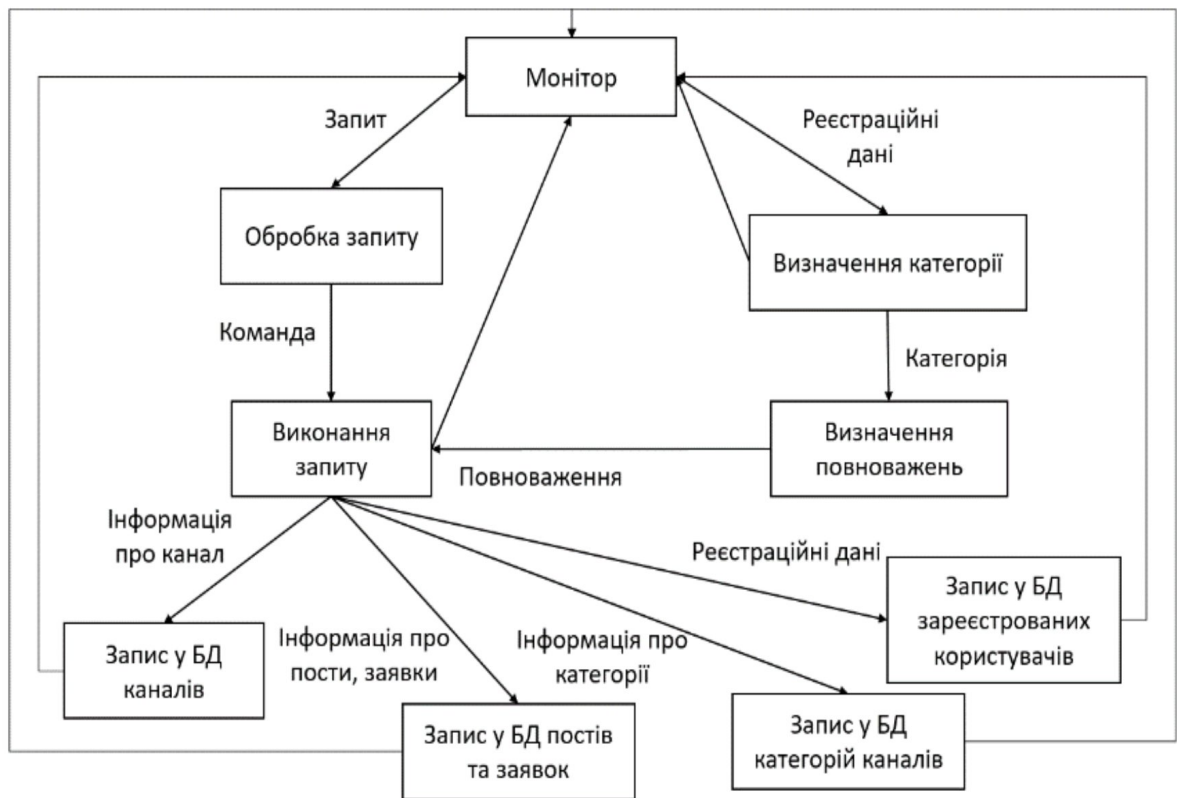
Рисунок 2.1.3.1 Модульна структура підсистеми обробки запитів та визначення категорій користувачів
