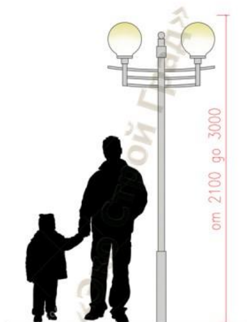
Рис. 4.6. Схематичне зображення і розміри світильника, мм
