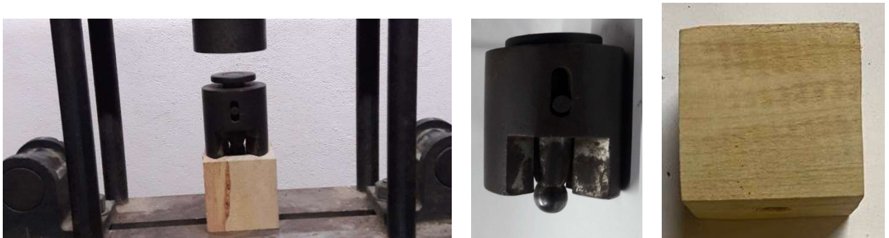
рис. 3.11. Лабораторна установка з приспособленнями для визначення статичної твердості
