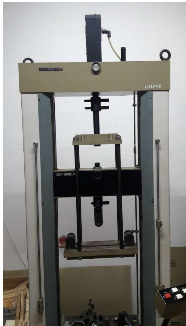
рис. 3.18. Лабораторна установка з приспособленнями для визначення основних параметрів деревини
