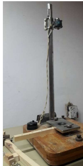
Рис. 3.8. Лабораторна установка з пристосуваннями для визначення ударної твердості
