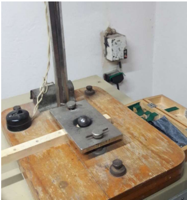
Рис. 3.8. Лабораторна установка з пристосуваннями для визначення ударної твердості
