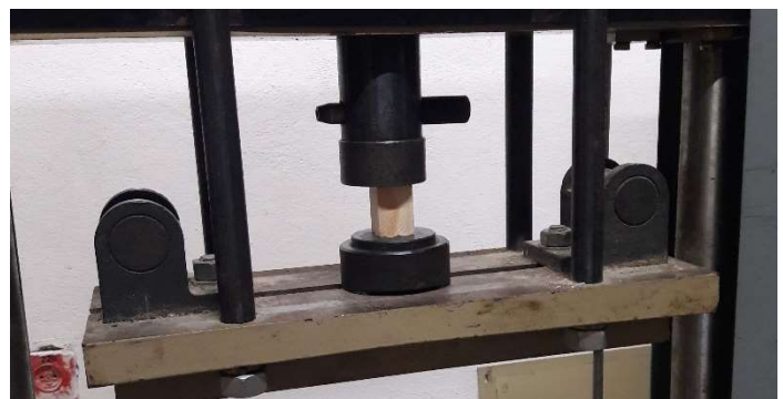
рис. 3.24. Лабораторна установка з приспособленнями для визначення основних параметрів деревини , зокрема на стиск.
