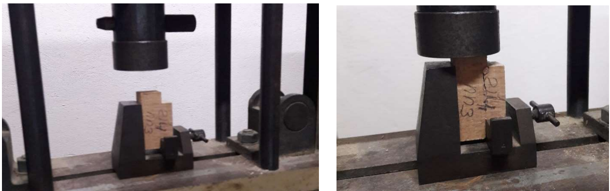
рис. 3.21. Лабораторна установка з приспособленнями для визначення основних параметрів деревини , зокрема на міцність при сколюванні
