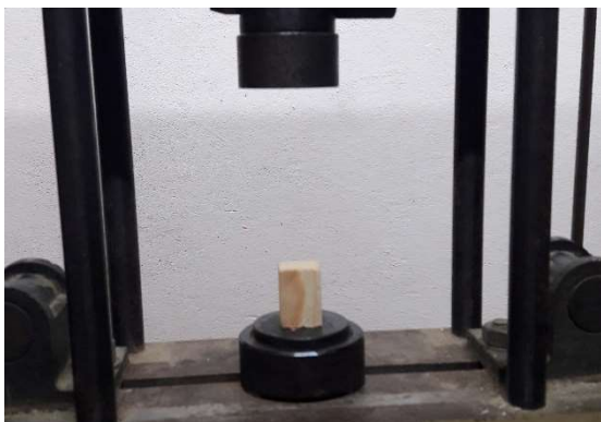
рис. 3.24. Лабораторна установка з приспособленнями для визначення основних параметрів деревини , зокрема на стиск.
