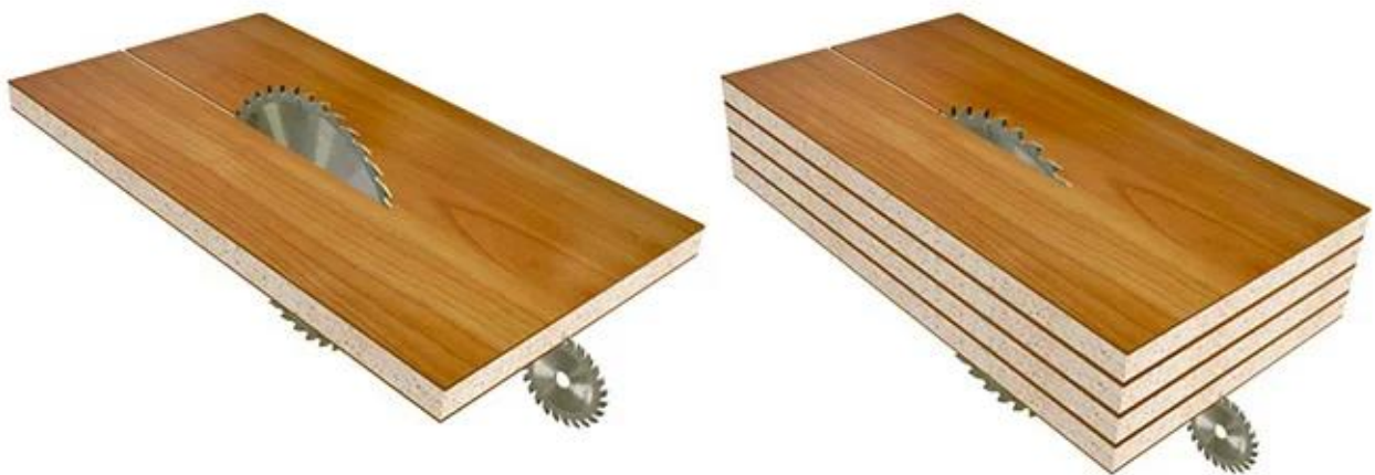
Рис. 5. Схема розкрою на форматно-розкрійному центрі з ЧПК
