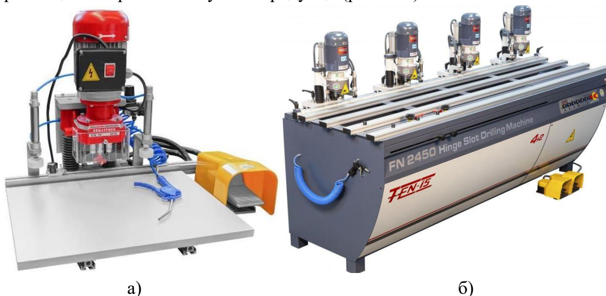
Рис. 18. Свердлильні верстати для формування отворів під меблеві завіси: а) настільний верстат з одним шпинделем, б) промисловий верстат з чотирма шпинделями
