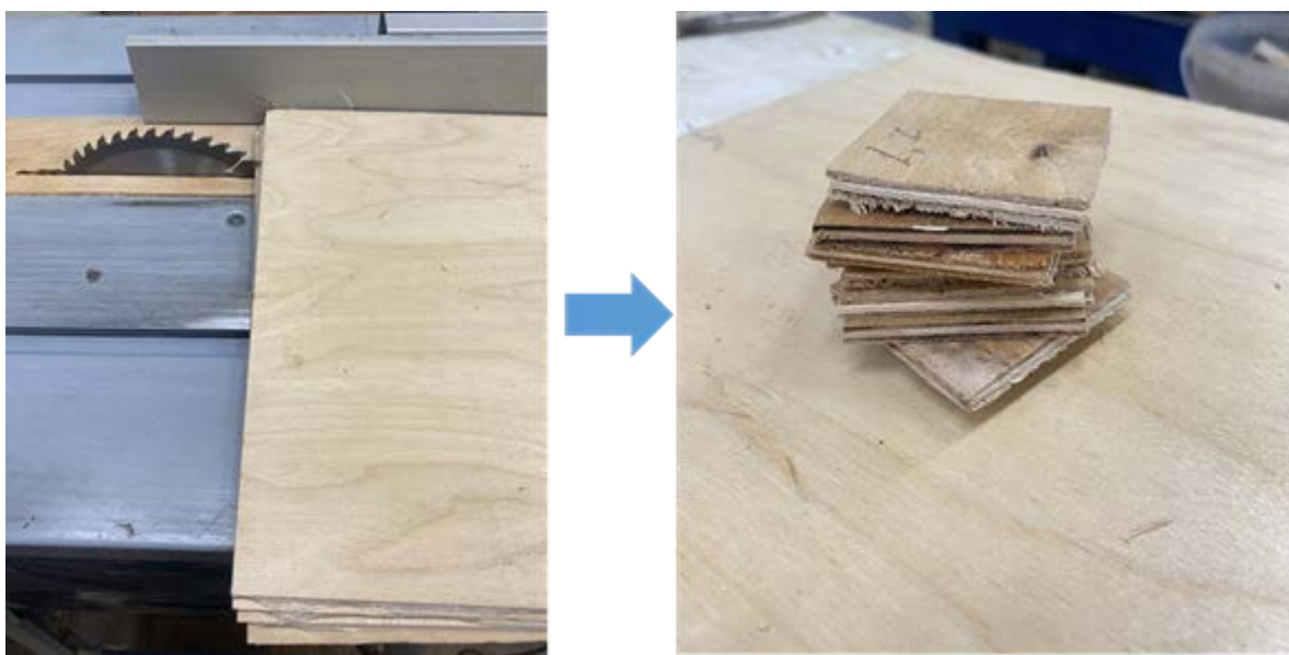
Рис. 2.9 – Підготовка зрізів фанери до випробувань
