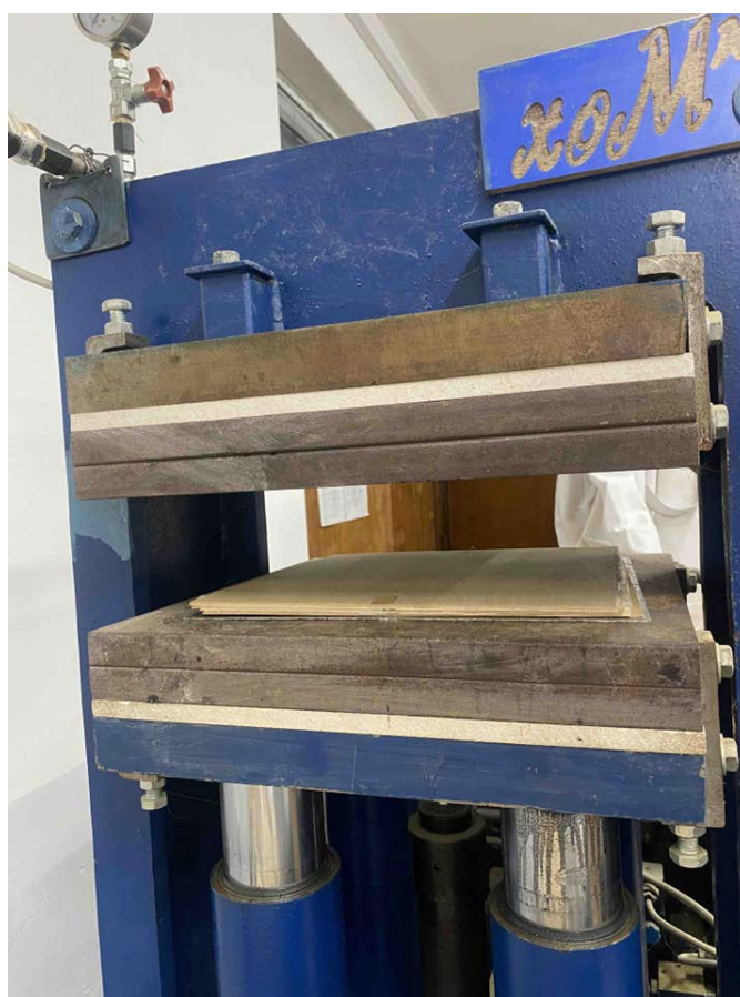
Рис. 2.7 – Робочий момент гарячого пресування пакета шпону в лабораторному пресі “Хомко”
