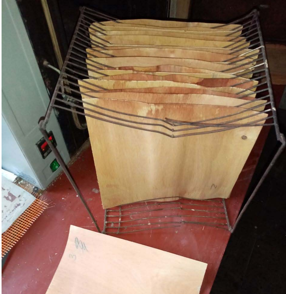
Рис. 2.2 – Сушіння шпону у сушильній шафі SNOL 67/350
