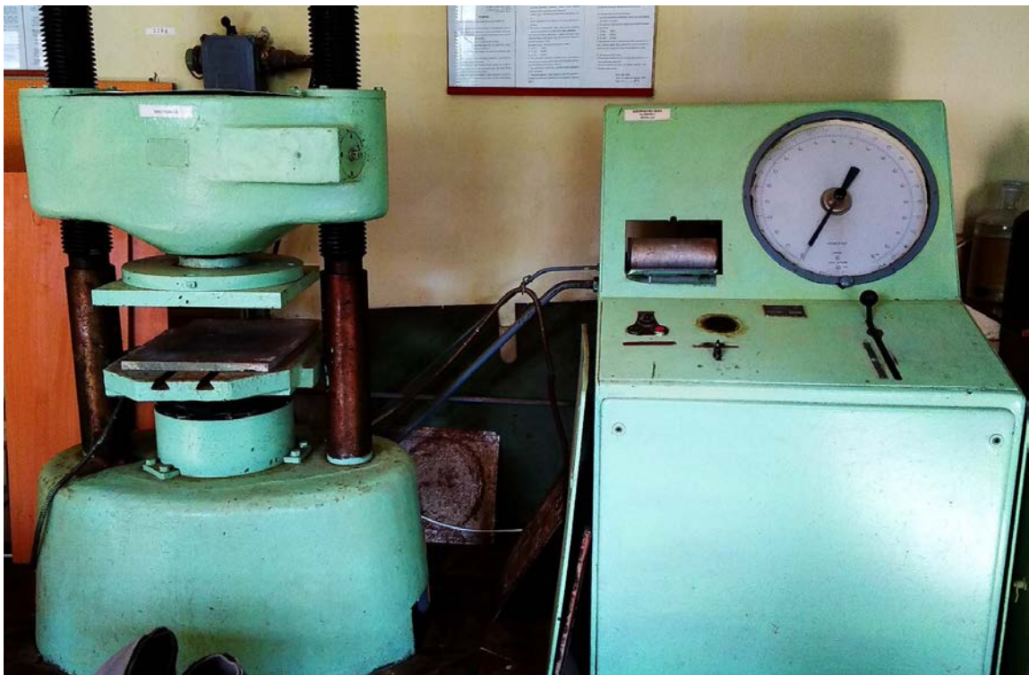
Рис. 2.8 – Лабораторний прес для холодного пресування “ ПММ-125”
