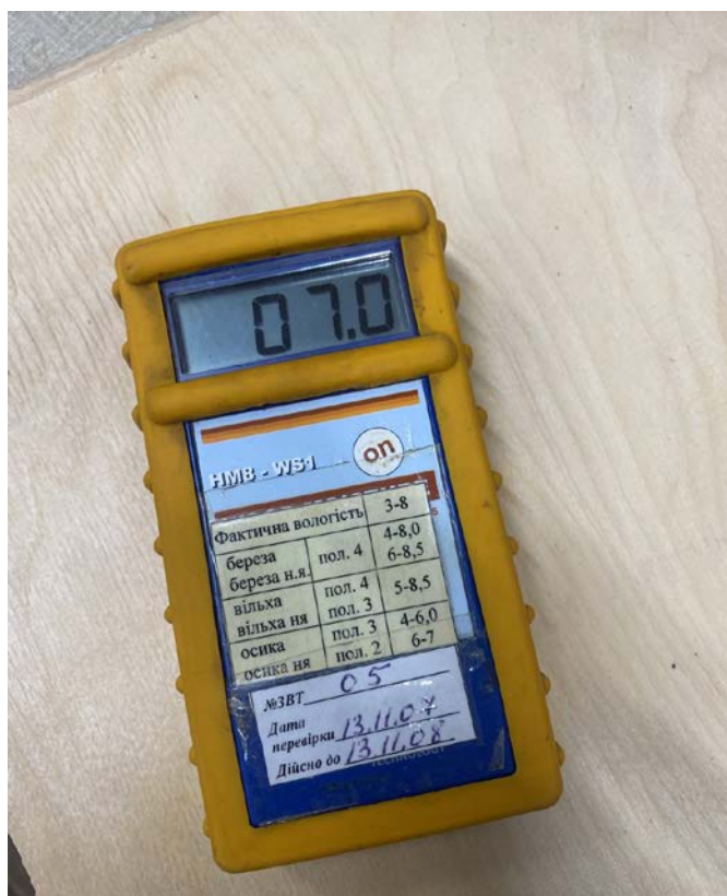
Рис. 2.3 – Визначення вологості луценого шпону вологоміром HMB-WS1
