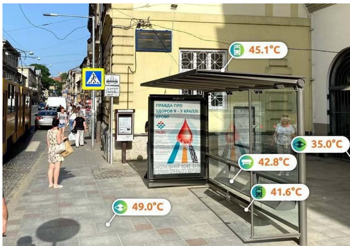
Рис. 4.2.5.- Вимірювання t поверхонь на вулиці Личківській м. Львова 24 липня 2024 р.
