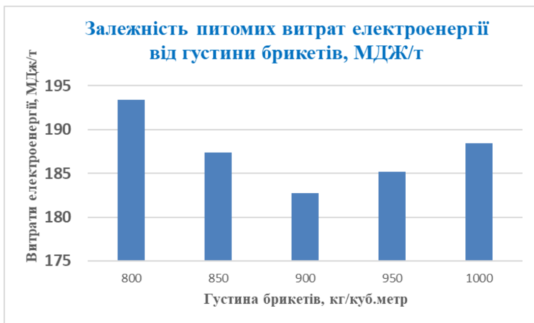
Рисунок 2.8. Діаграма питомих витрат електричної енергії брикетувальною машиною RUF в залежності від густини деревинних паливних брикетів.
