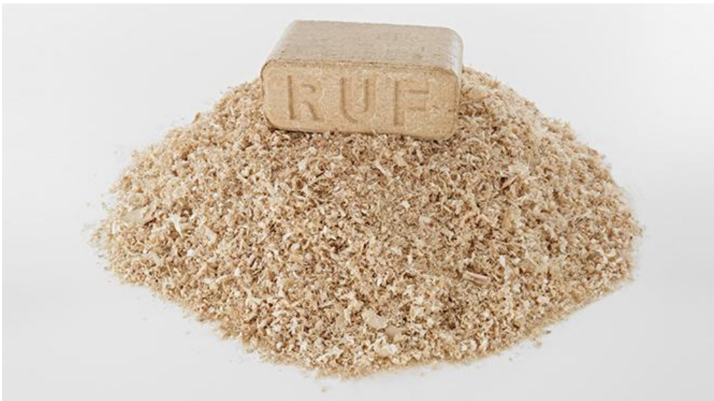
Рисунок 1.6. Ілюстрація перетворення сухих подрібнених відходів деревини (тирса, стружка) в прямокутні брикети RUF.
