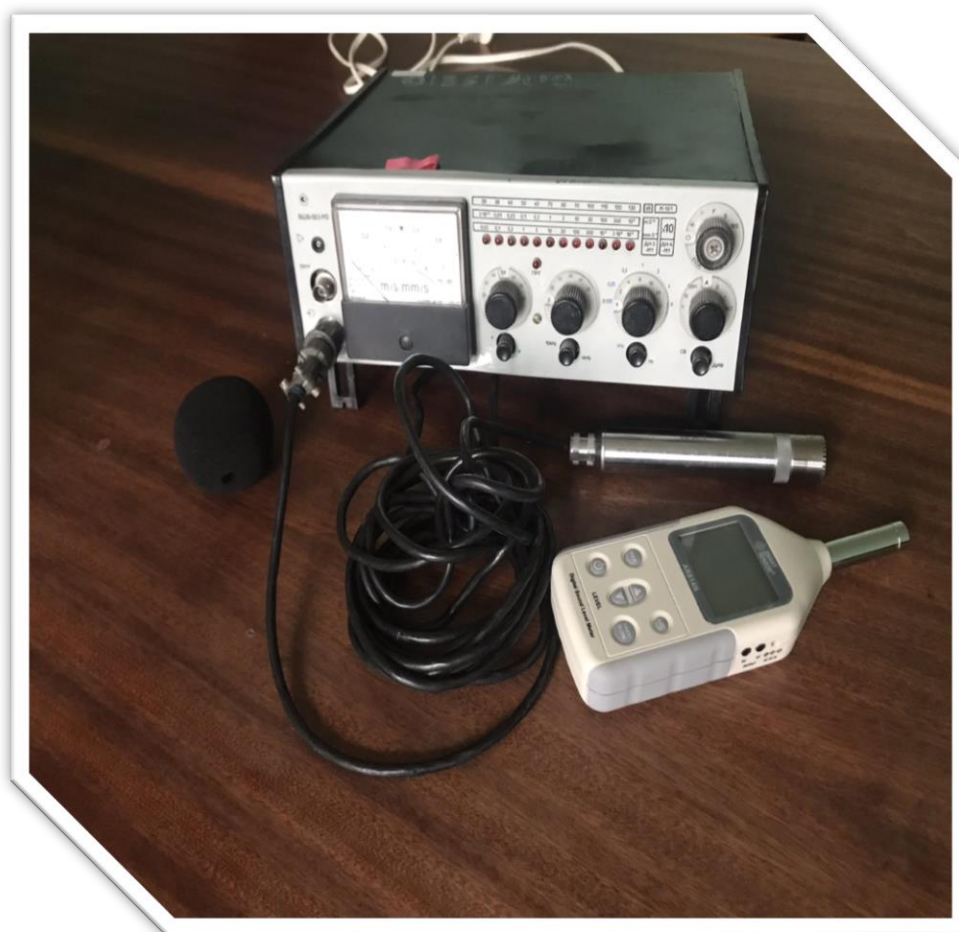
Рис.2.1 Вимірювальні прилади: ВШВ-001, портативний вимірювач шуму
