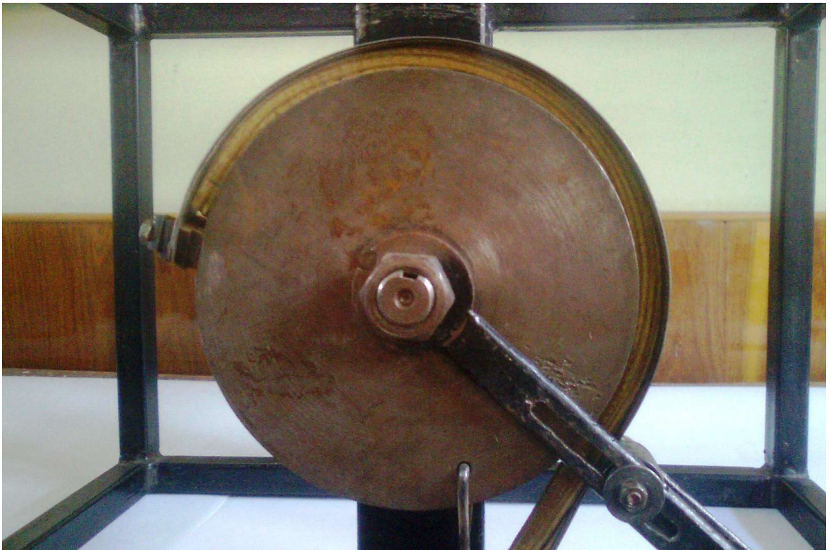
Рис.2.10. Рух ручного притисного механізму у гнударному експериментальному лабораторному пристосібленні з отриманням дуги 295-305 мм
