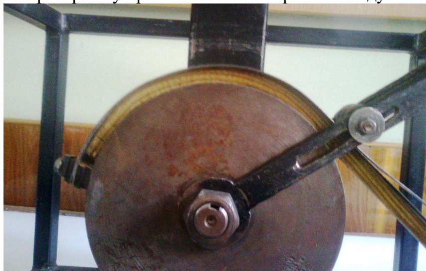
Рис.2.8. Рух ручного притисного механізму у гнударному експериментальному лабораторному пристосібленні з отриманням дуги 190-210 мм
