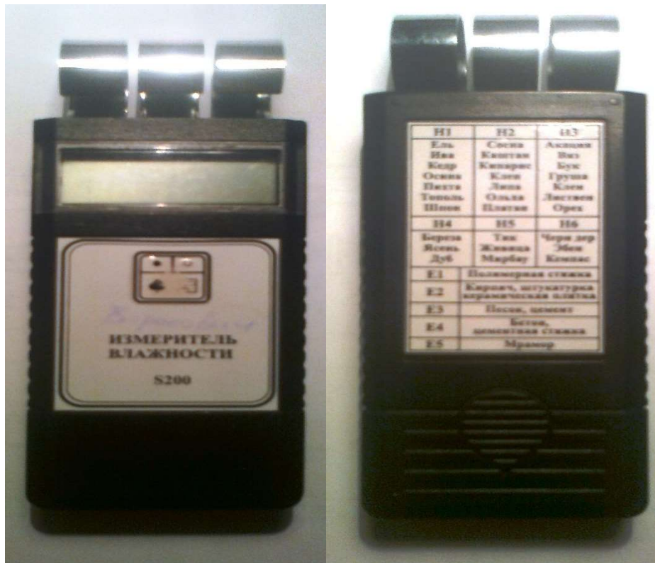
Рис. 2.2. Прилад для контролю та вимірювання вологості SW-200A
