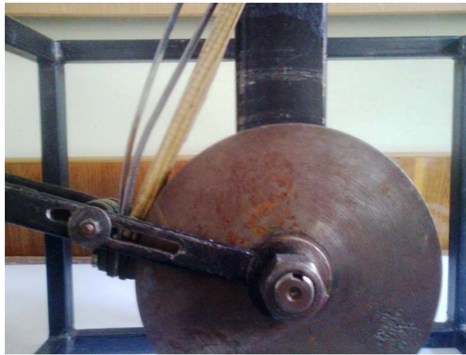
Рис.2.6. Закладання взірця в гнударний експериментальний лабораторний механізований пристрій у притисний механізм ручного приводу
