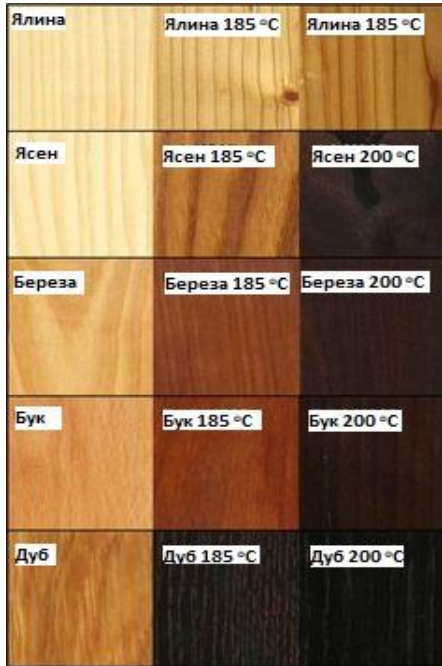
Рисунок 3.3. Зміна кольору термічно модифікованої деревини
