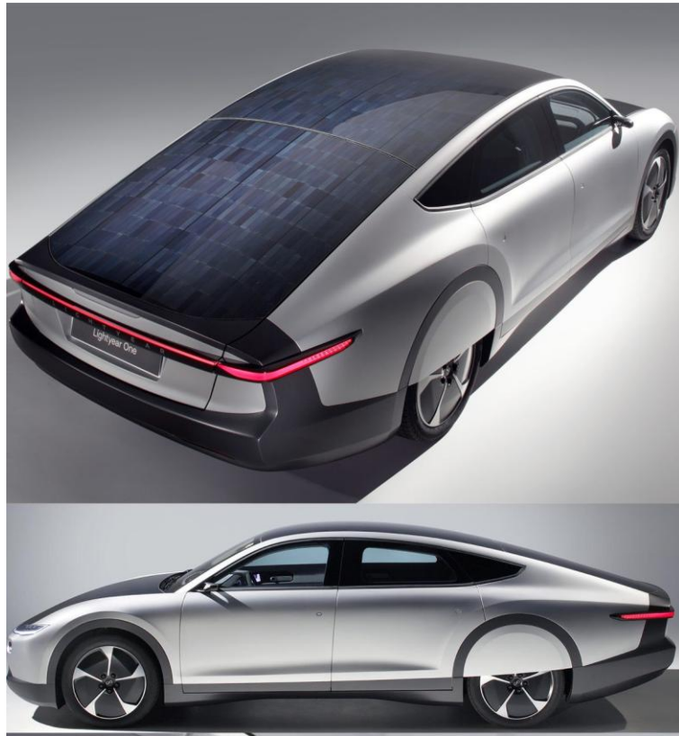
Іл. 3.2 Інтеграція сонячних панелей в елементи кузова
