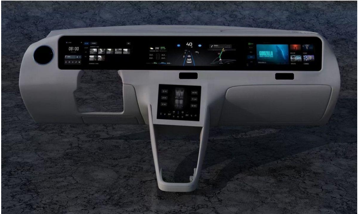
Іл. 2.2 Панель приладів виконана за допомогою 3D-друку
