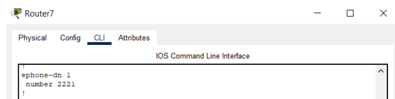
Рисунок 4.18 – присвоєння номеру телефону «2221» першому IP-телефону
