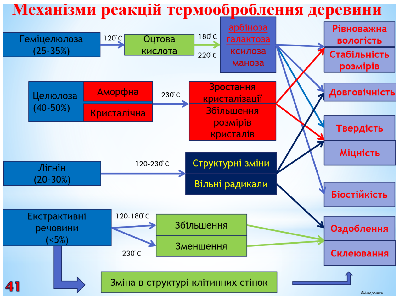
Рисунок 1.1. Механізми хімічних реакцій термічної модифікації деревини.
