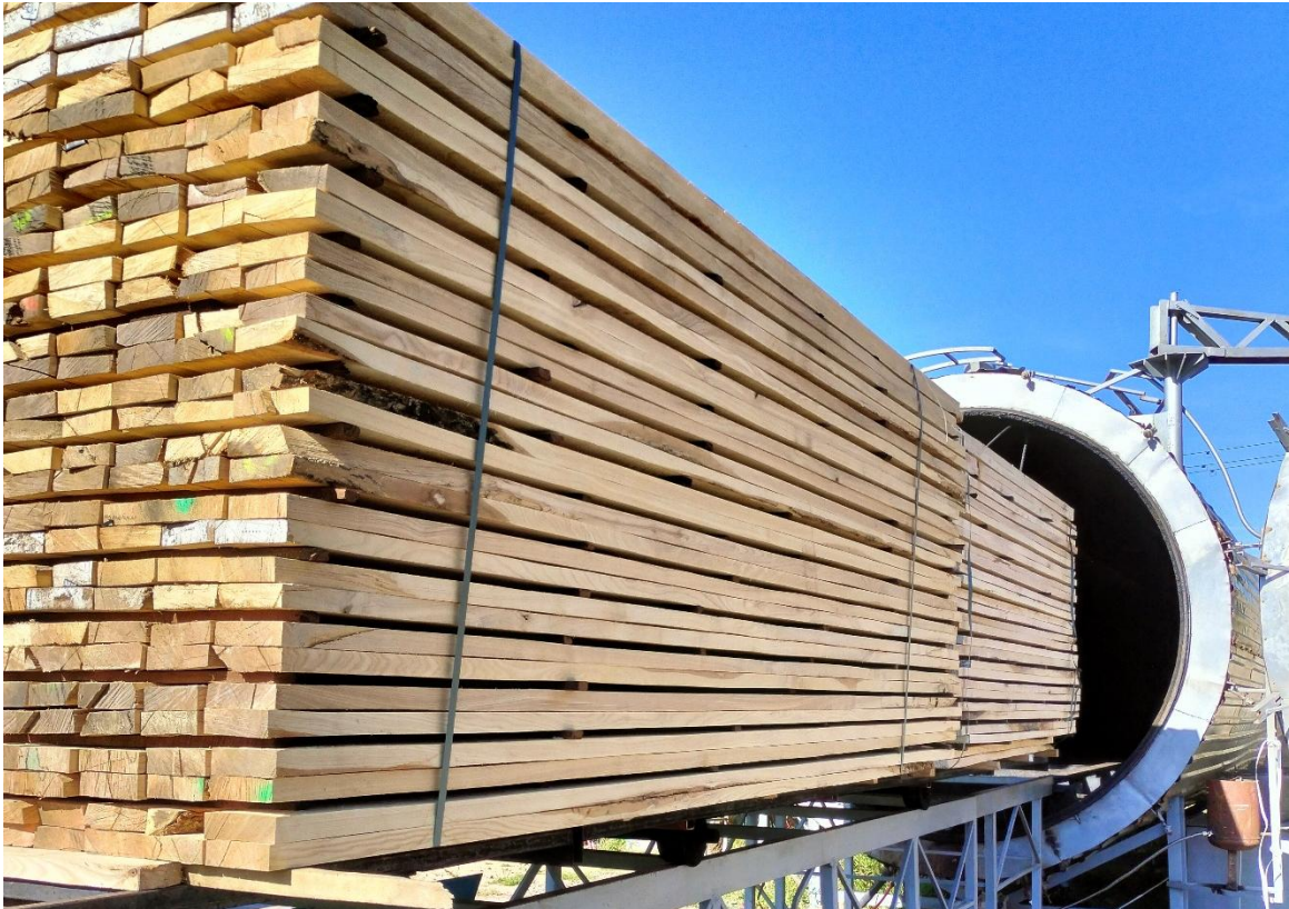
Рисунок 2.2. Фотографія загального вигляду термокамери для термічної модифікації деревини підприємства “Long Life Wood”.
