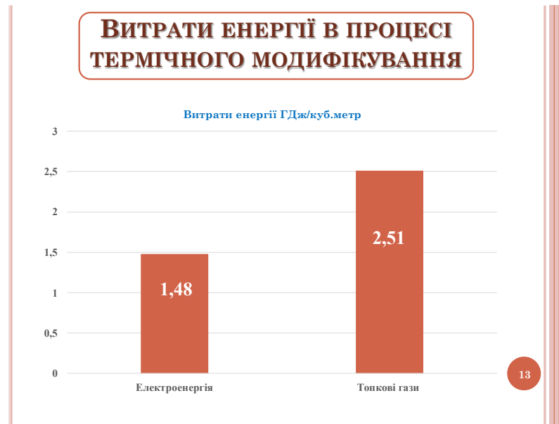
Рисунок 2.6. Питомі витрати електроенергії і топкових газів в процесі термічної модифікації деревини.
