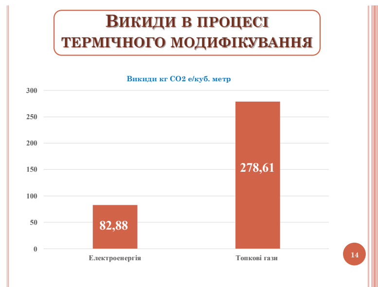
Рисунок 2.7. Питомі викиди вуглекислого газу в еквіваленті в процесі термічної модифікації деревини при використанні різних видів енергії.
