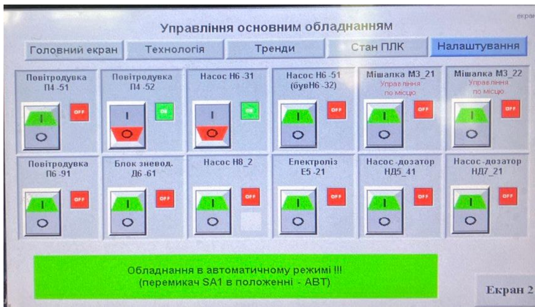
Рис. 3.5 Автоматичне управління обладнання для очищення стічних вод Для первинної очистки стічних вод целюлозо-паперового виробництва використовують первинні відстійники. Для подальшої очистки використовують
