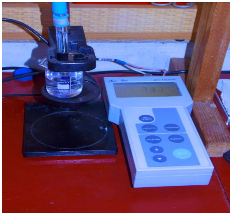
Рисунок 2.6 – Робочий момент визначення концентрації йонів Гідрогену
