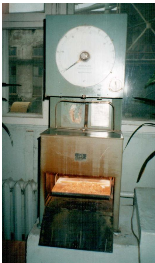
Рисунок 2.8 Робочий момент визначення вологості клейової композиції
