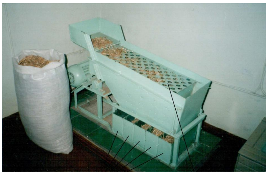
Рисунок 2.2 Робочий момент визначення фракційного складу пшеничних солом'яних частинок за допомогою ситового механічного аналізатора АЛГ-М: 1 – набір контрольних сит з отворами діаметром 30, 15, 10, 5 мм; 2 – піддони
