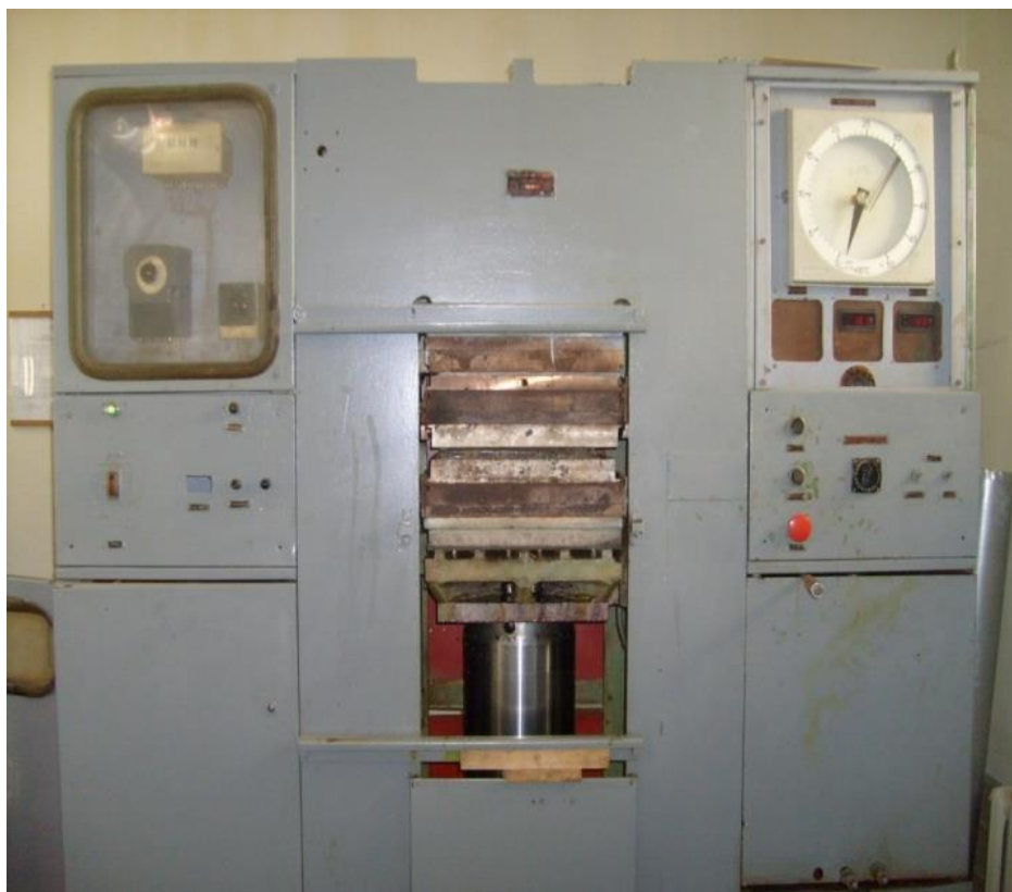
Рисунок 2.11 Робочий момент пресування дослідних зразків деревинно-солом'яних плит на лабораторному пресі
