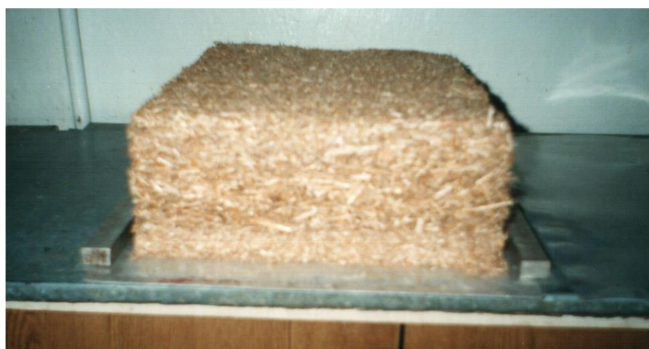
Рисунок 2.10 Зовнішній вигляд стружкового пакета при виготовленні дослідних зразків деревинно-солом'яної плити
