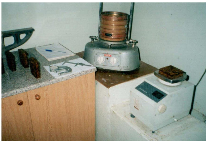
Рисунок 2.18 Робочий момент визначення розмірів і маси зразків після витримування їх у воді для визначення водопоглинання і набрякання за товщиною деревинно-солом'яних плит
