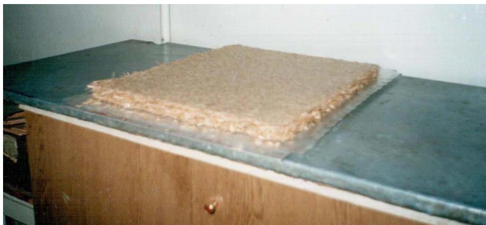
Рисунок 2.12 Зовнішній вигляд спресованого дослідного зразка деревинно-солом'яної плити
