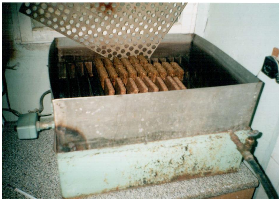
Рисунок 2.17 Робочий момент проведення випробування на визначення водопоглинання і набрякання за товщиною зразків деревинно-солом'яних плит
