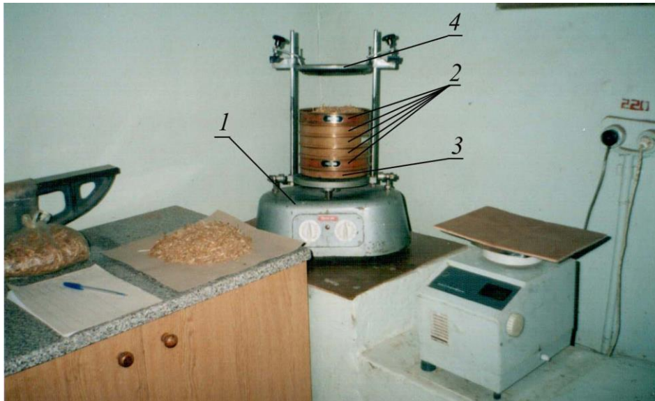
Рисунок 2.3 Ситоаналізатор для визначення фракційного складу частинок: 1 – корпус; 2 – набір контрольних сит розмірами 6,3; 4; 2; 1; 0,63; 0,4 мм; 3 – піддон; 4 - кришка
