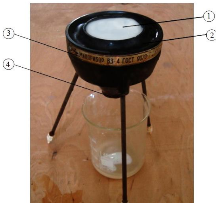
Рисунок 2.5 – Робочий момент визначення умовної в'язкості за допомогою віскозиметра ВЗ-4: 1 – карбамідоформальдегідний клей; 2 – циліндричний резервуар; 3 – штатив; 4 – сопло віскозиметра.
