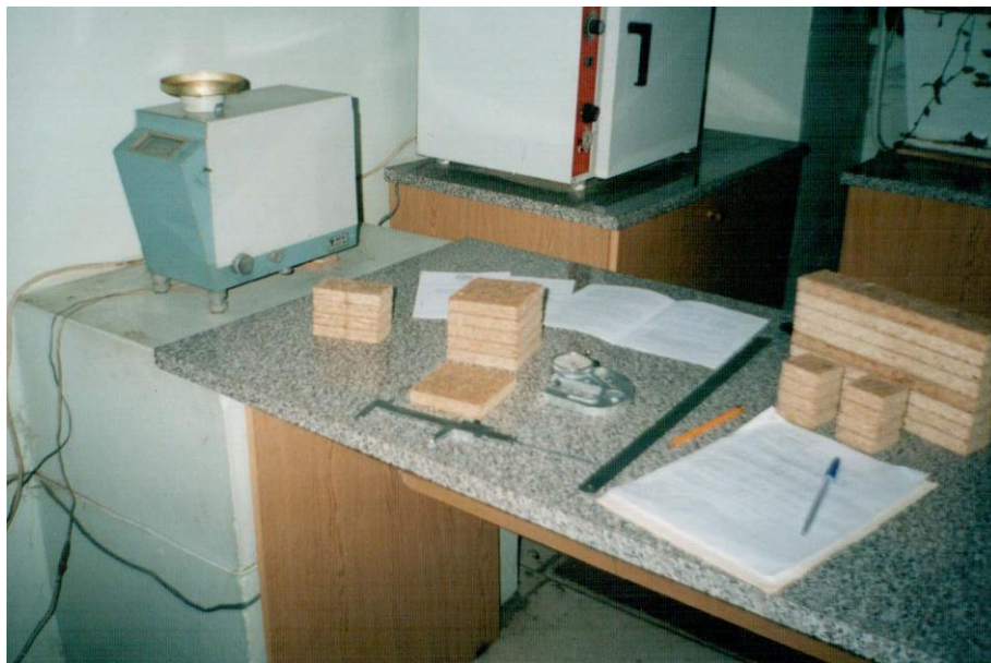
Рисунок 2.13 Робочий момент визначення розмірів і маси зразків перед фізико-механічними випробуваннями
