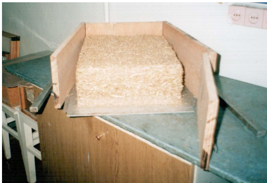
Рисунок 2.9 Робочий момент формування стружкового пакета
