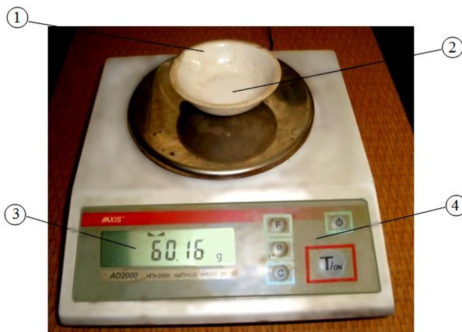
Рисунок 2.7 – Робочий момент зважування смоли у фарфоровій чашці під час визначення концентрації клею: 1 – фарфорова чашка; 2 – карбамідоформальдегідний клей; 3 – шкала вимірювань; 4 – панель керування.
