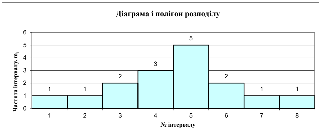
Рис. 3.1. Діаграма та полігон розподілу отриманих даних щодо величини показника міцності під час згинання столярного щит, отриманого шляхом склеювання рейок при ширині 40 міліметрів методом на гладку фугу
