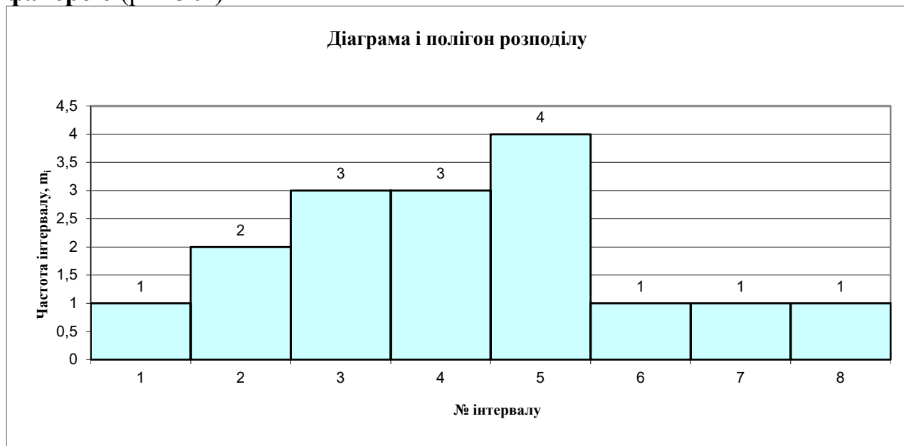
Рис. 3.9. Діаграма та полігон розподілу отриманих даних щодо величини показника міцності під час згинання столярної плити, отриманої шляхом склеювання рейок при ширині 40 міліметрів та личкової фанерою
