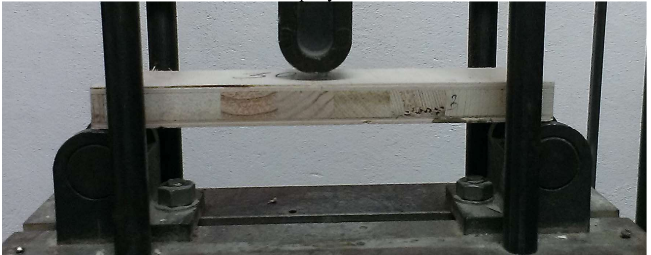
Рис. 2.3. Схема організації випробування міцності на статичний згин
