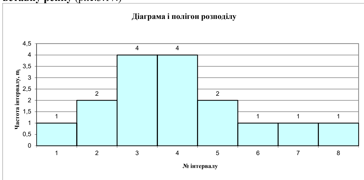
Рис. 3.17. Діаграма та полігон розподілу отриманих даних щодо величини показника міцності під час сколювання столярного щит, отриманого шляхом склеювання рейок при ширині 40 міліметрів методом на вставну рейку
