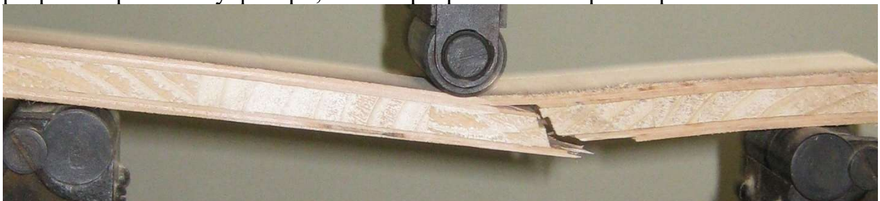
Рис. 3.12. Момент руйнації під час статичного навантаження зразків, отриманих із щитових конструкцій із вживаної деревини
