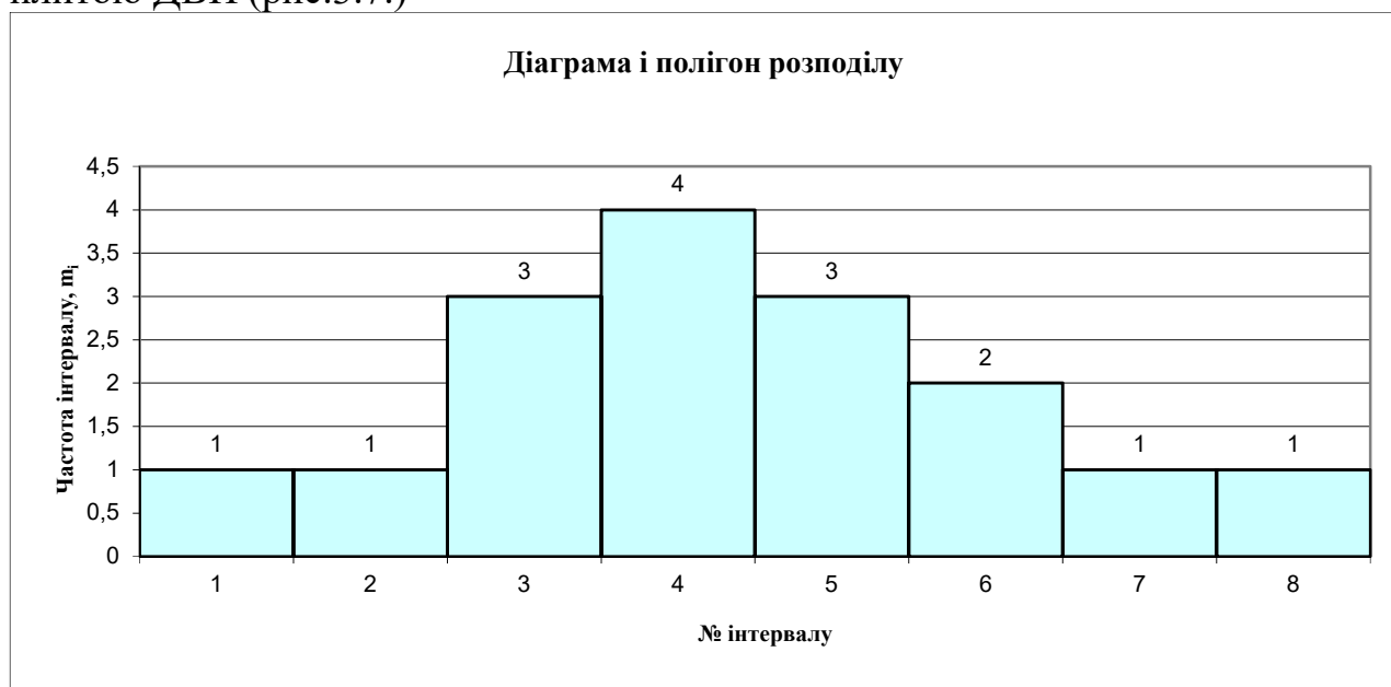
Рис. 3.7. Діаграма та полігон розподілу отриманих даних щодо величини показника міцності під час згинання столярної плити, отриманої шляхом склеювання рейок при ширині 40 міліметрів та личкової плитою ДВП
