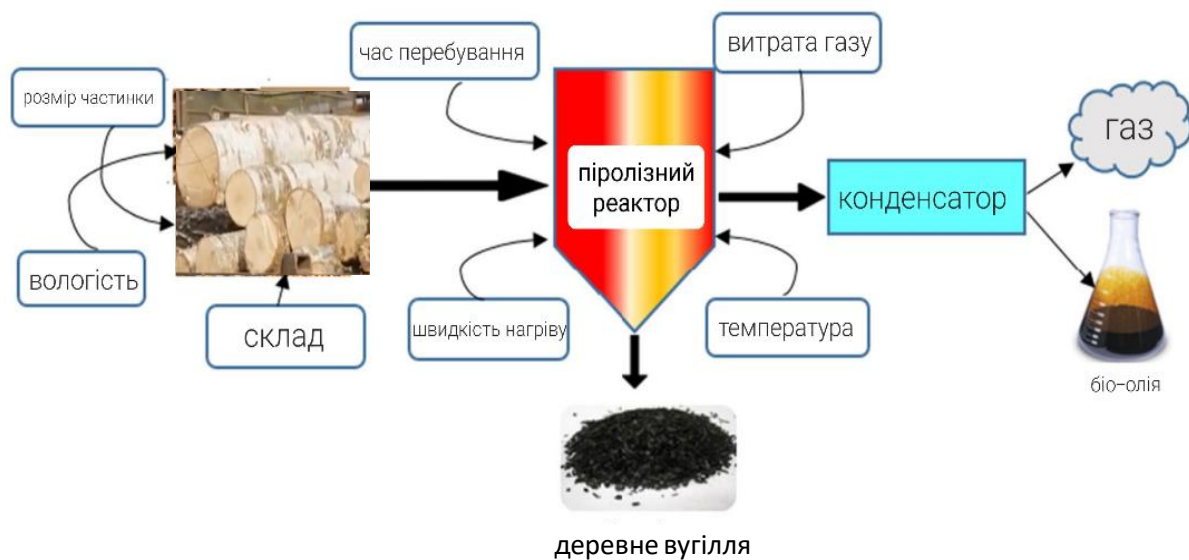
Рис. 7. Структурно-технологічна схема перероблення низькосортної деревини і деревинних залишків до деревного вугілля за допомогою піролізу (схема адаптована із статті [47])
