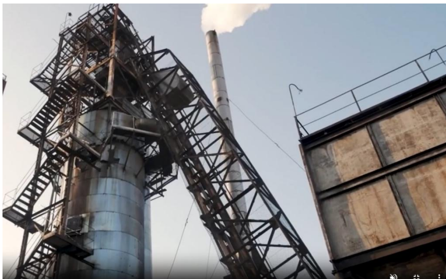
Рис. 19. Реторта, у якій відбувається процес піролізу лісопереробної сировини
