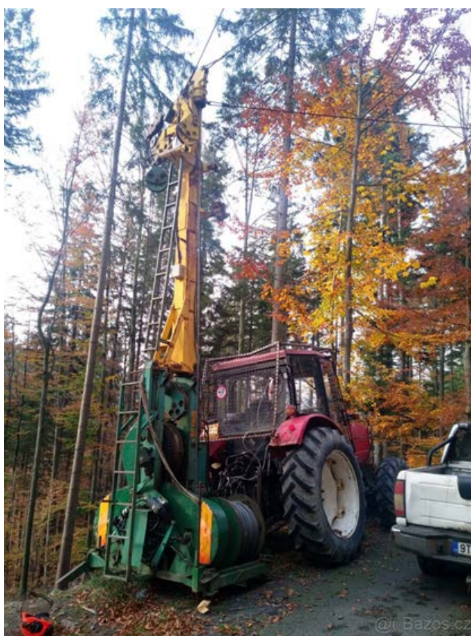
Рисунок 3.2. Загальний вигляд мобільної канатно-підвісної установки «Larix 3T»
