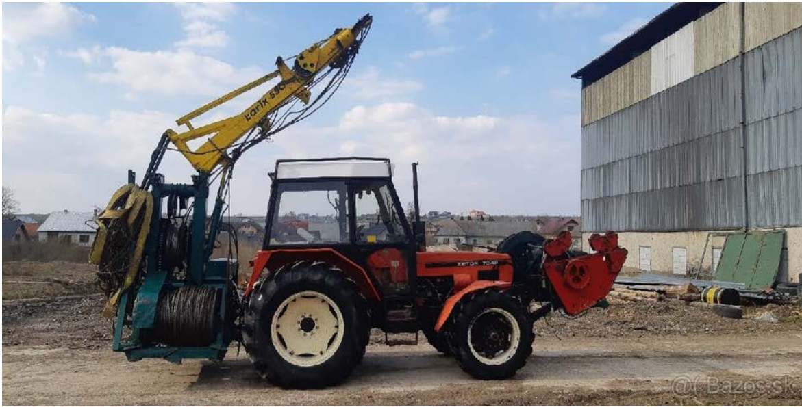
Рисунок 3.3 – Загальний вигляд мобільної канатно-підвісної установки «Larix 550»
