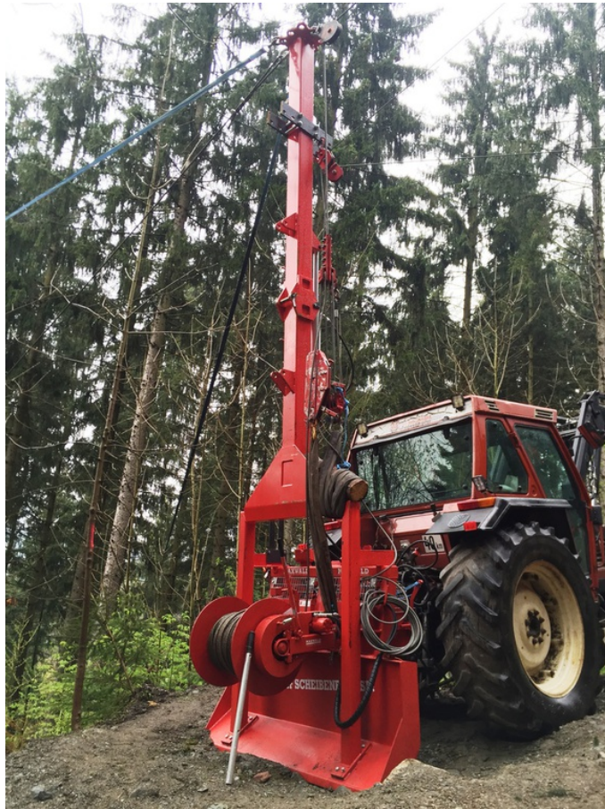
Рисунок 3.4 – Загальний вигляд мобільної канатно-підвісної установки «MAXWALD»
