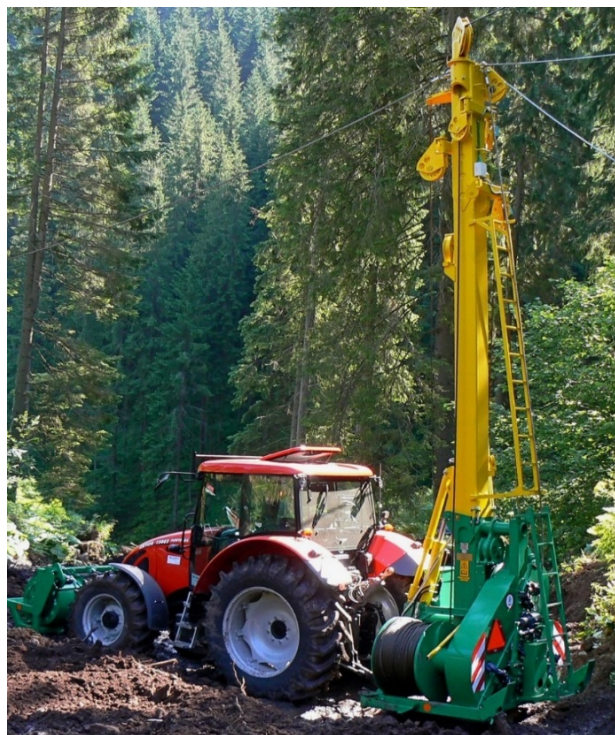
Рисунок 3.2. Загальний вигляд мобільної канатно-підвісної установки «Larix 3T»
