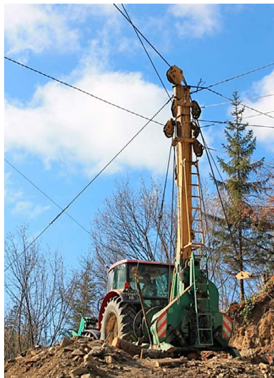
Рисунок 3.2. Загальний вигляд мобільної канатно-підвісної установки «Larix 3T»
