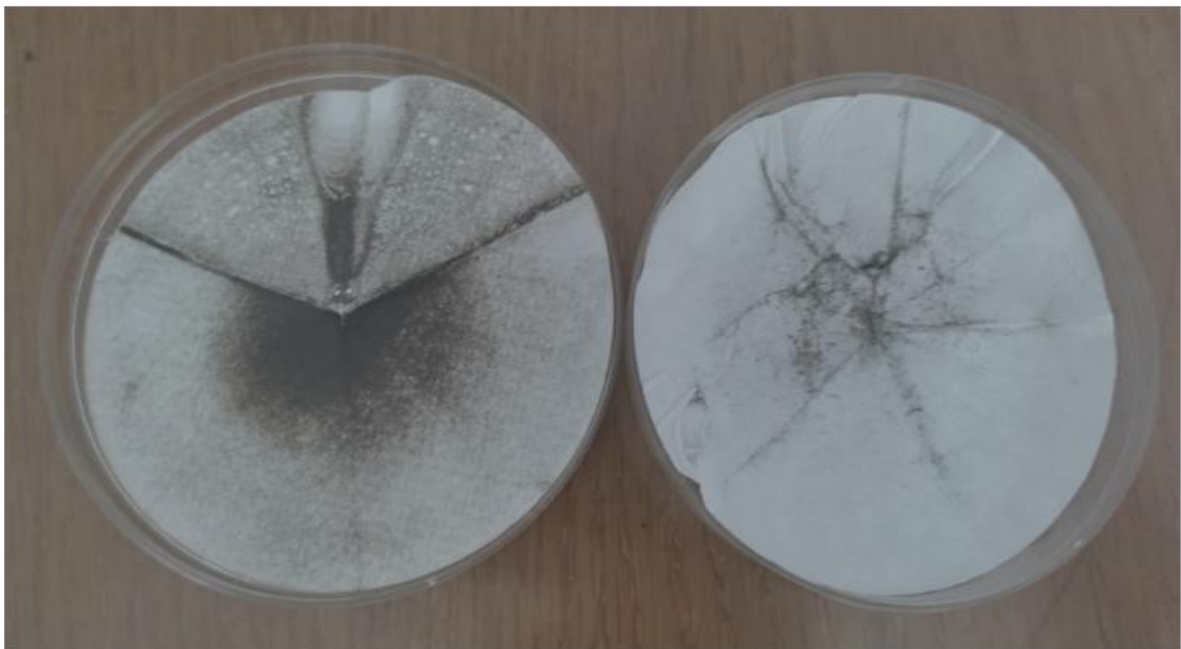
Рис 9. Фільтри з осадом після фільтрування стічних вод автомийних станцій з різних колодязів
