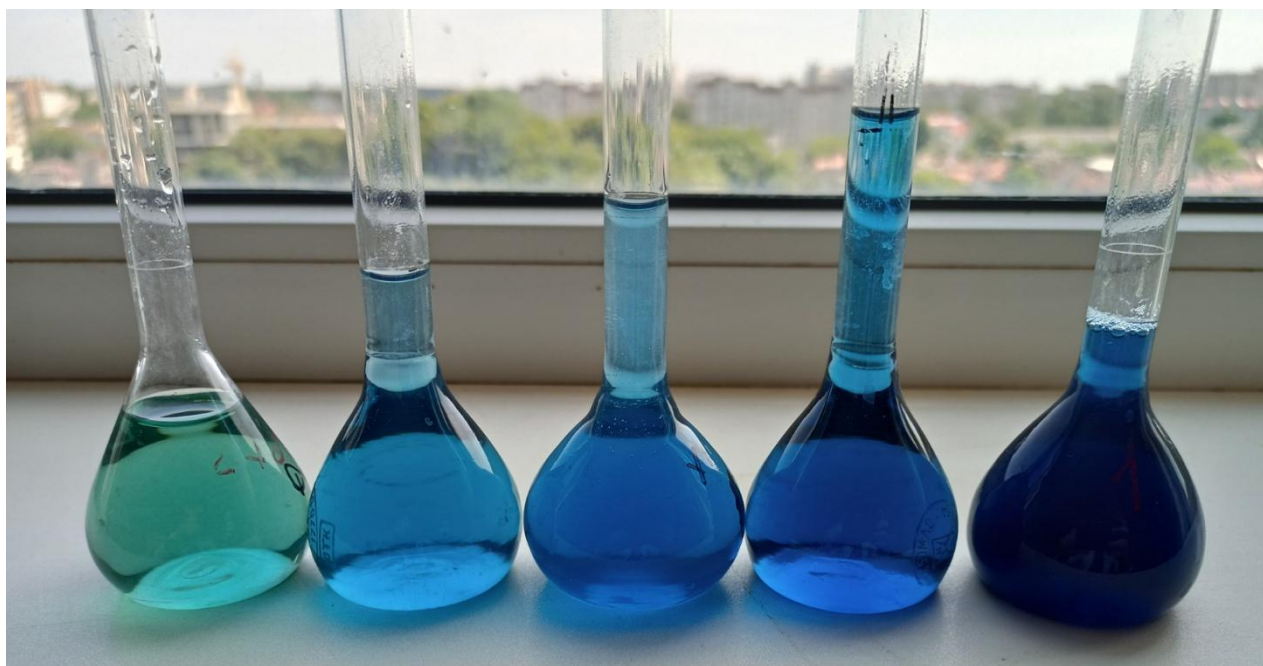
Рис. 15. Розчини фосфатів з концентраціями 0,04; 0,06; 0,10; 0,14; 0,18; мг \text{PO}_4^{3-} мг/мл, що фотометруються і використовуються для побудови градуйованого графіка
