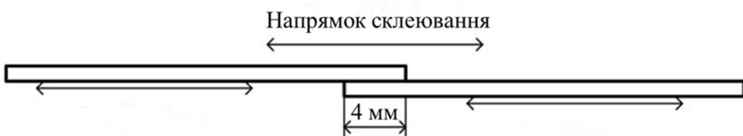
Рис. 2.2. Схематичне зображення формування листів шпону перед склеюванням
