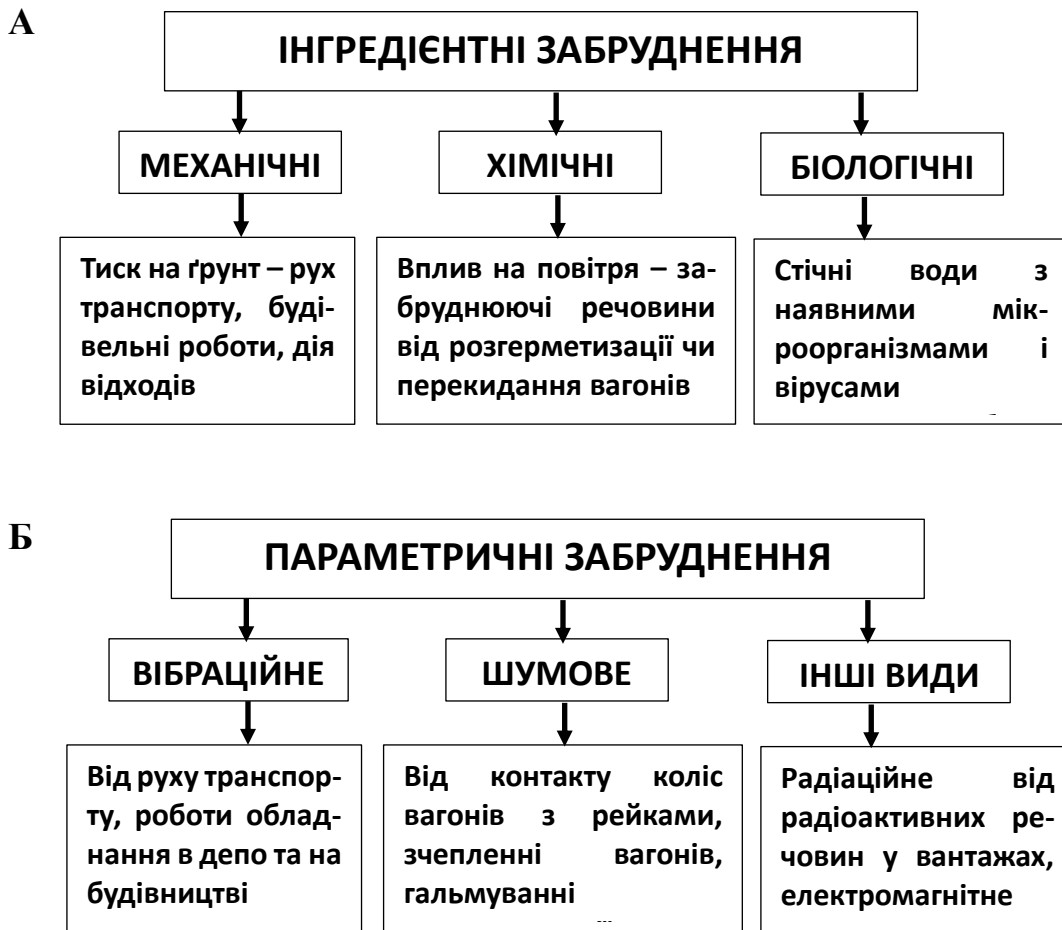
Рис. 5. Класифікація інгредієнтних (А) та параметричних (Б) забруднень, спричинених функціонування залізничного транспорту та дотичної до нього інфраструктури
