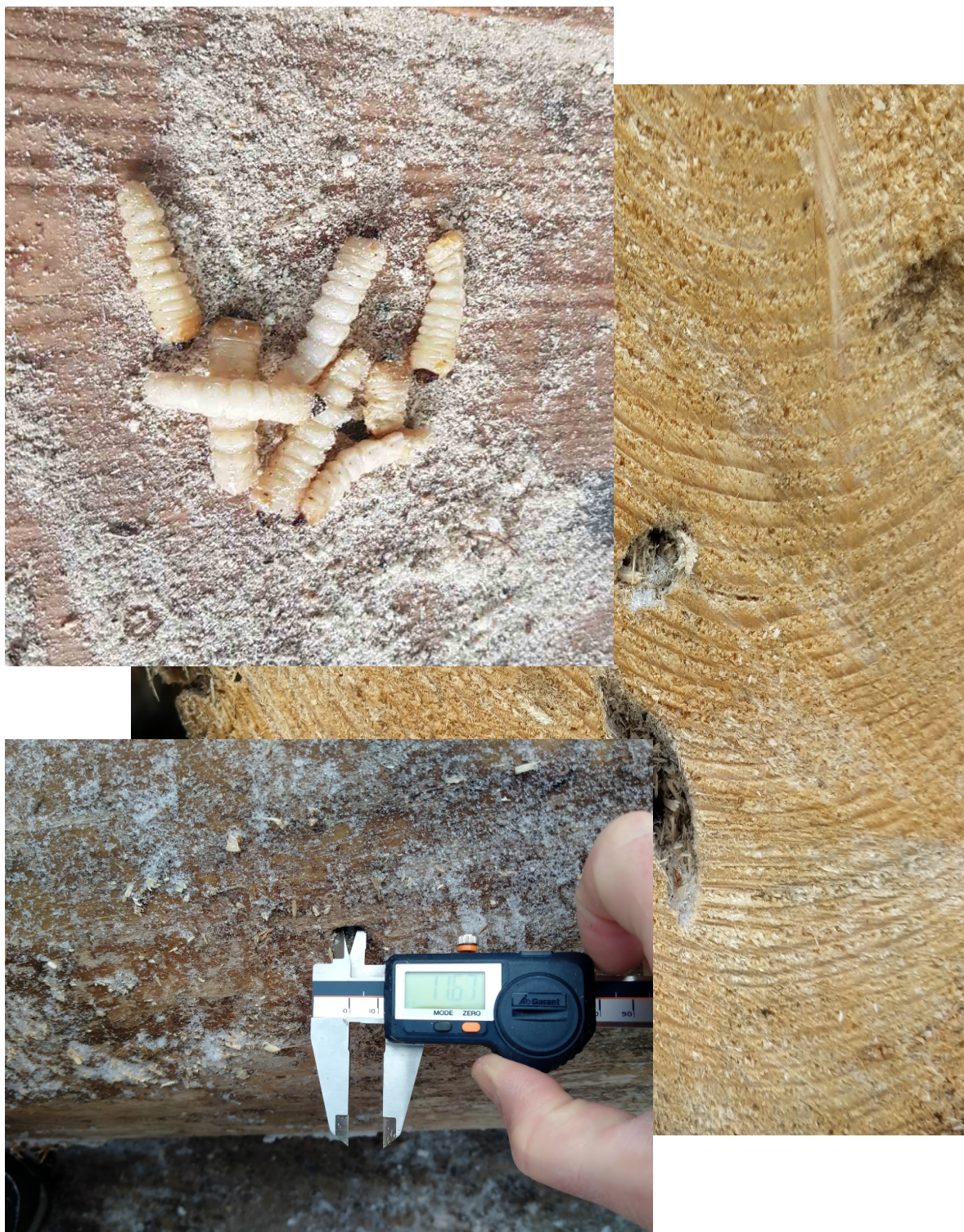
Рис. 2.10 – Пошкодження деревини личинками чорного ялицевого вусача ( Monochamus urussovi ) та їх вимірювання
