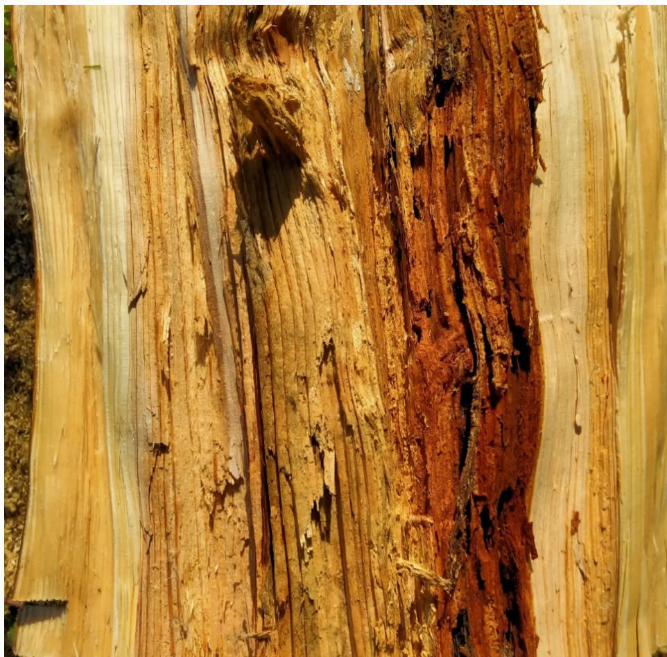
Рис. 2.9 – Бура тріщинувата гнилизна деревини
