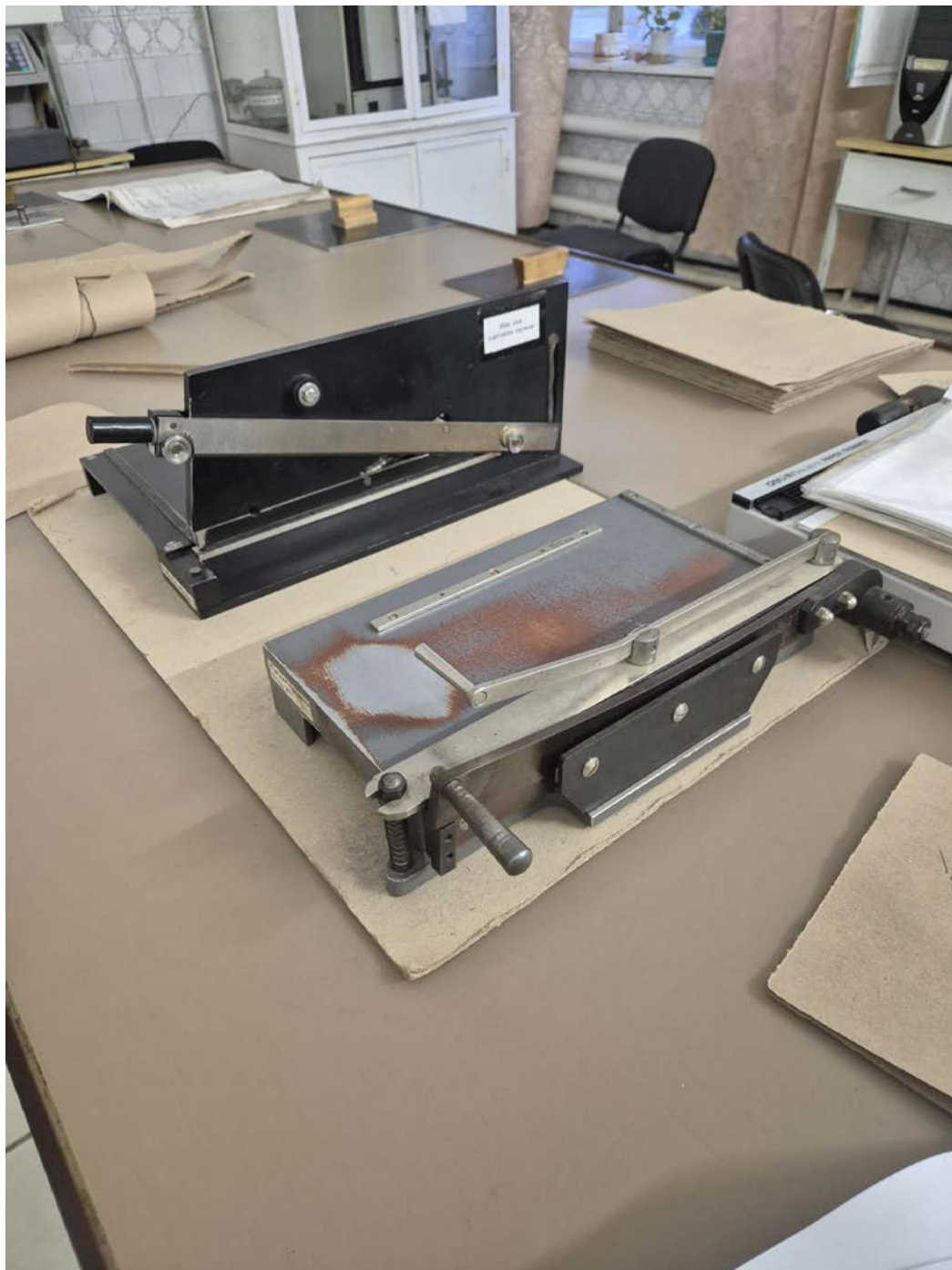
Рис. 2.2 – Прилад для розкроювання зразків картону
