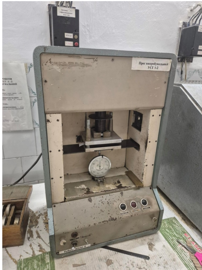
Рис. 2.5 – Прес випробувальний УСТ-1-2
