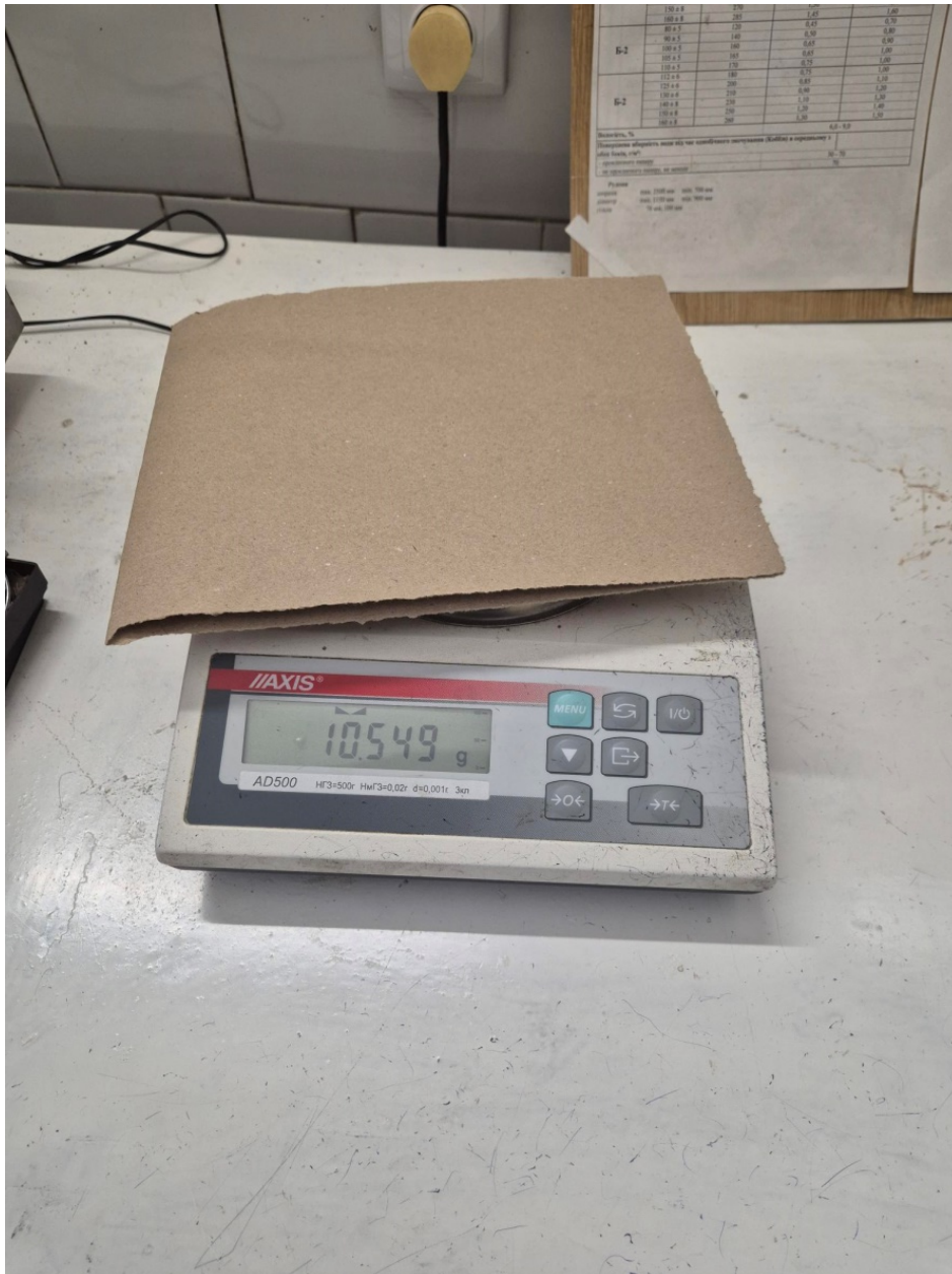
Рис. 2.3 – Момент зважування зразків картону
