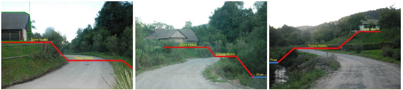
Рисунок 3.6 Принцип розташування житлових будинків на терасах.
