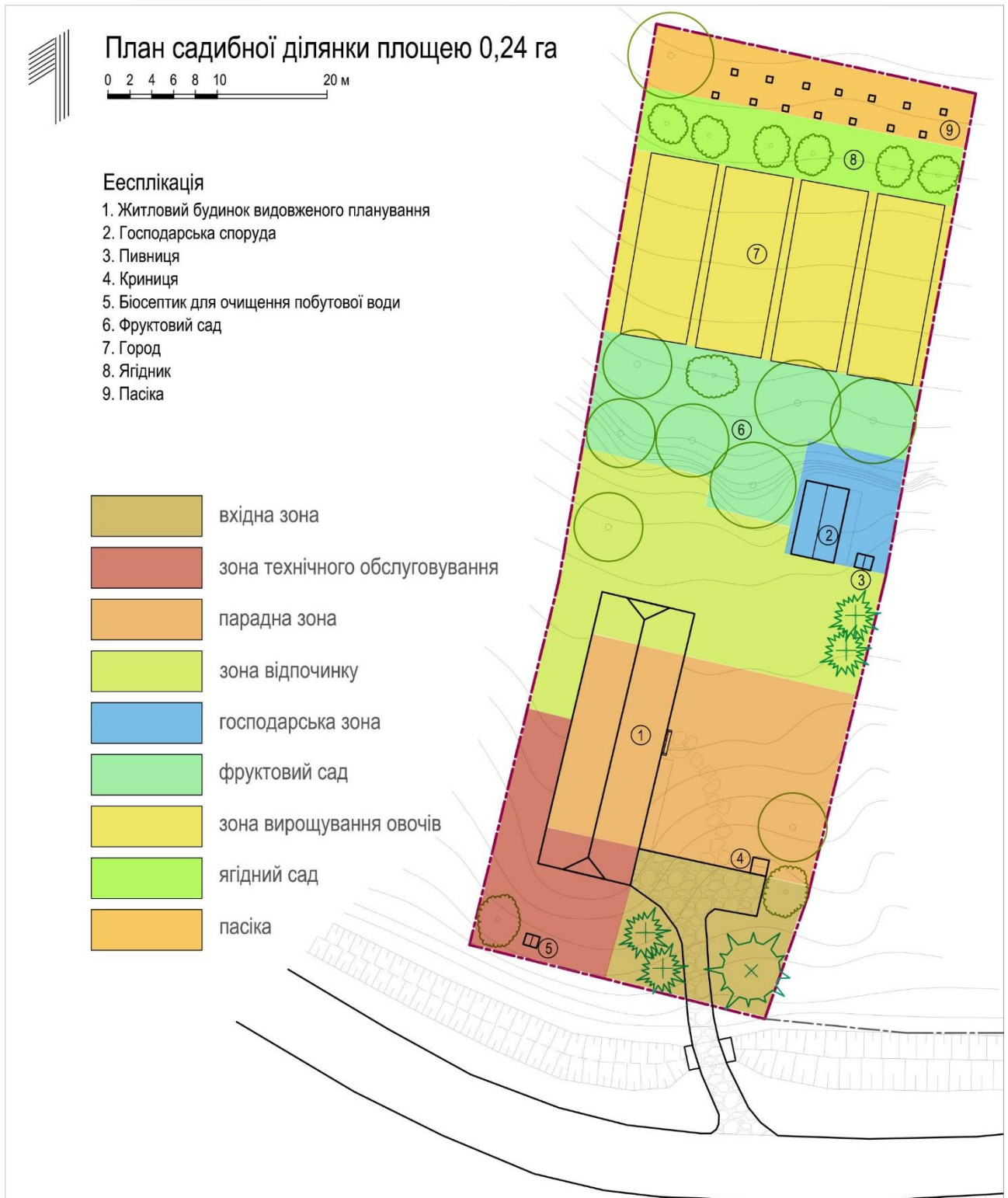
Рисунок 5.5 Функціональне зонування для другого типу ділянок.
