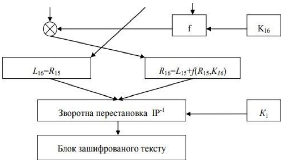
Рис. 2.6. Блок-схема криптосистеми шифрування DES
