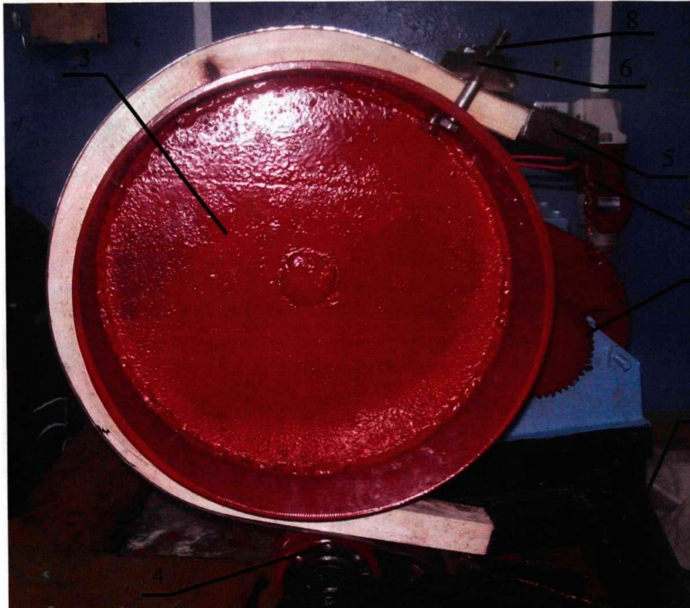
Рис. 2.7. Лабораторна гнутарна установка: 1 – станина, 2 – привід, 3 – шаблон, 4 - пресуючий ролик, 5 – шина, 6 -струбцина, 7 - регулювальний гвинт, 8 - фіксуєчий гвинт, 9 - петля
