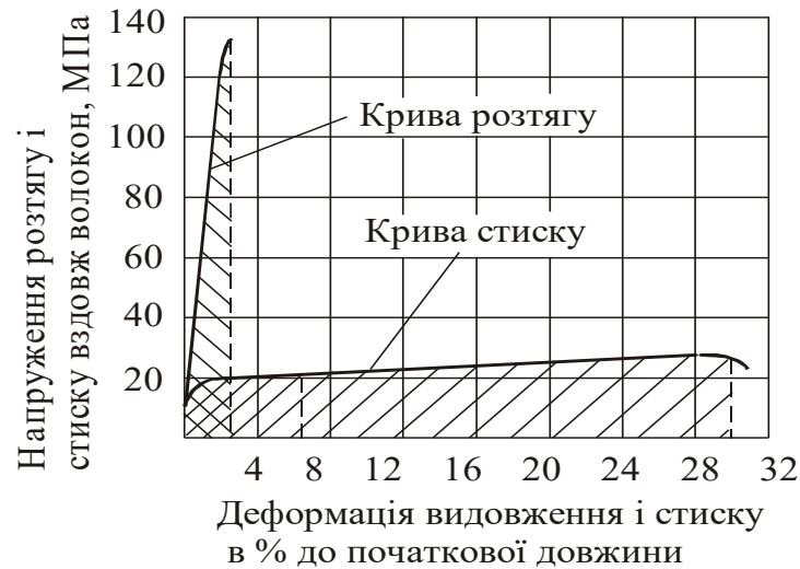
Рис. 1.1. Діаграма напруг та деформації деревини при гнутті за Леонтєвим І.І.
