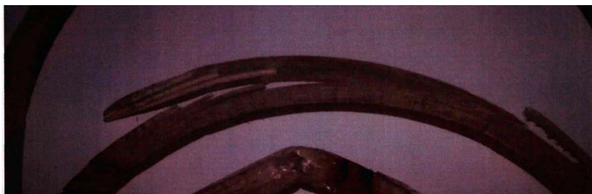
Рис. 3.8. Руйнування деревини під час гнуття
