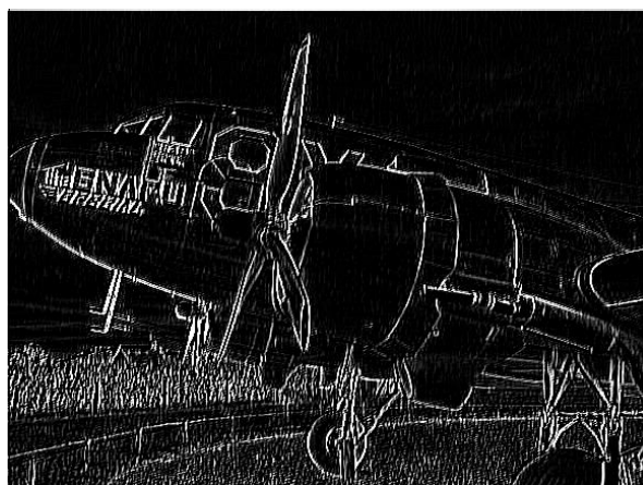
Рис. 4.20. Зображення опрацьоване фільтром «Границі» (матриця 4x4)
