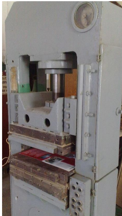
Рис. 2.3. Прес для склеювання заготовок.
