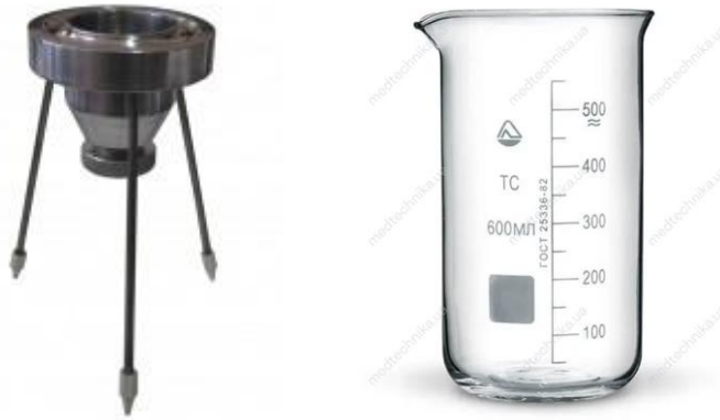
Рис. 2.2. Віскозиметр ВЗ 4 та скляна колба для розмішування клею
