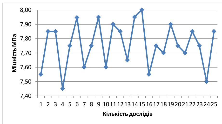
Рис.4.1. Міцність клейових з'єднань деревини сосни
