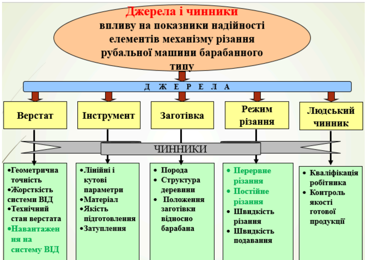
Рисунок 1.7 – Схема джерел та чинників, які чинять вплив на показники надійності вузлів та деталей рубальних машин
