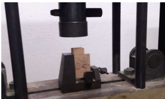
р-и-с. 3.17. Виконавчий пристрій для визначення показника : Міцність при сколюванні при W=12\% , H \cdot \text{мм}^{-2} для чотирьох шпилькових порід таких як ялиця, модрина, ялина та сосна
