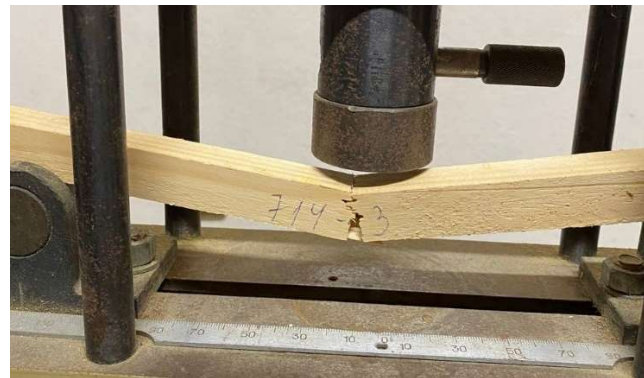
р-и-с. 3.15. Руйнування взірців : Міцність при статичному згині при W=12\% , H \cdot \text{мм}^2 для чотирьох шпилькових порід таких як ялиця, модрина, ялина та сосна
