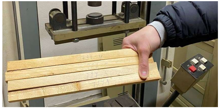
р-и-с. 3.14. Виконавчий пристрій для визначення показника : Міцність при статичному згині при W=12\% , H \cdot \text{мм}^2 для чотирьох шпилькових порід таких як ялиця, модрина, ялина та сосна
