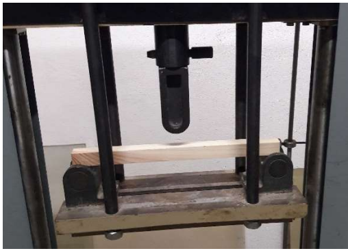
р-и-с. 3.14. Виконавчий пристрій для визначення показника : Міцність при статичному згині при W=12\% , H \cdot \text{мм}^2 для чотирьох шпилькових порід таких як ялиця, модрина, ялина та сосна
