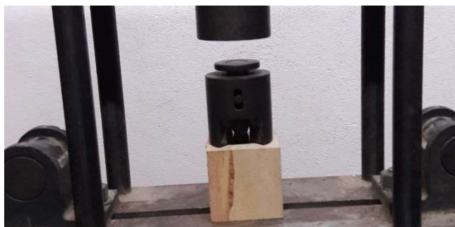
р-и-с. 3.10. Виконавчий пристрій для визначення показника : Твердість статична при W=12\% , N \cdot mm^{-2} для чотирьох шпилькових порід таких як ялиця, модрина, ялина та сосна
