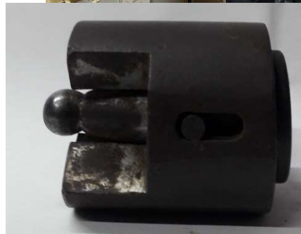
р-и-с. 3.10. Виконавчий пристрій для визначення показника : Твердість статична при W=12\% , N \cdot mm^{-2} для чотирьох шпилькових порід таких як ялиця, модрина, ялина та сосна
