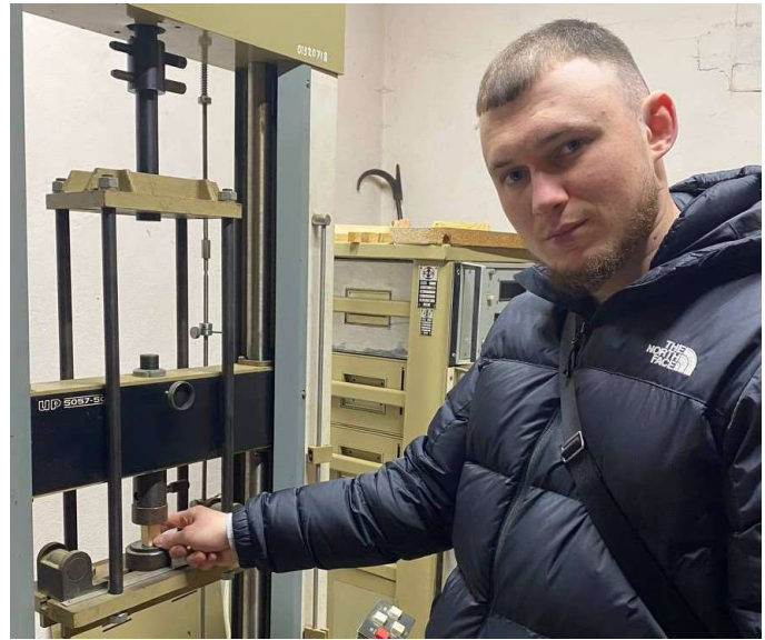
р-и-с. 3.20. Виконавчий пристрій для визначення показника : Міцність при стиску при W=12\% , H \cdot \text{мм}^2 для чотирьох шпилькових порід таких як ялиця, модрина, ялина та сосна
