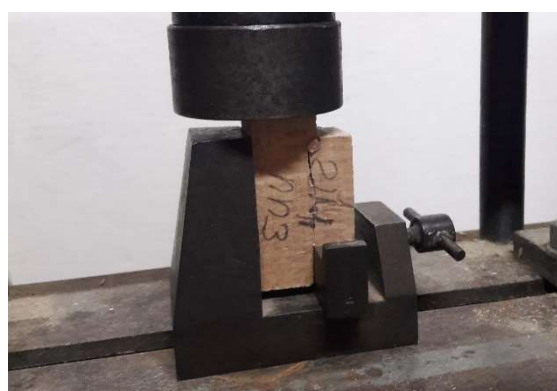
р-и-с. 3.17. Виконавчий пристрій для визначення показника : Міцність при сколюванні при W=12\% , H \cdot \text{мм}^{-2} для чотирьох шпилькових порід таких як ялиця, модрина, ялина та сосна
