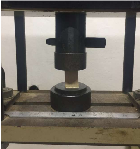
р-и-с. 3.20. Виконавчий пристрій для визначення показника : Міцність при стиску при W=12\% , H \cdot \text{мм}^2 для чотирьох шпилькових порід таких як ялиця, модрина, ялина та сосна
