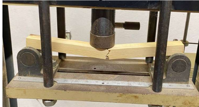
р-и-с. 3.14. Виконавчий пристрій для визначення показника : Міцність при статичному згині при W=12\% , H \cdot \text{мм}^2 для чотирьох шпилькових порід таких як ялиця, модрина, ялина та сосна
