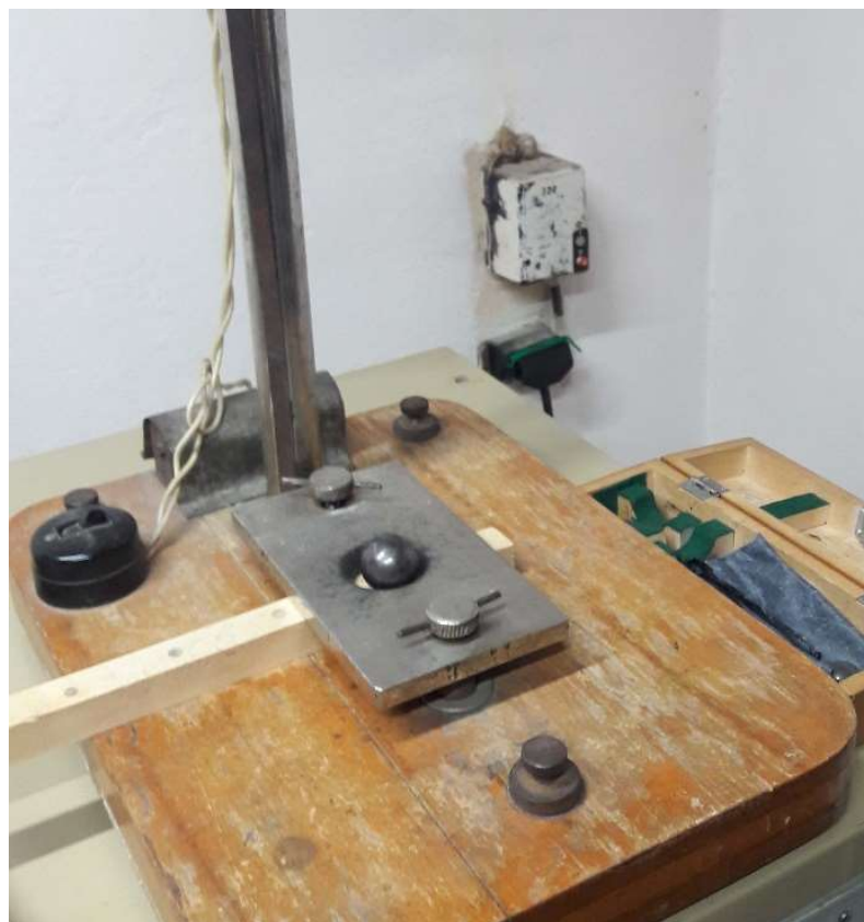
р-и-с. 3.7. Виконавчий пристрій для визначення показника : Твердість ударна при W=12\% , \text{кДж}\cdot\text{м}^{-2} для чотирьох шпилькових порід таких як ялиця, модрина, ялина та сосна
