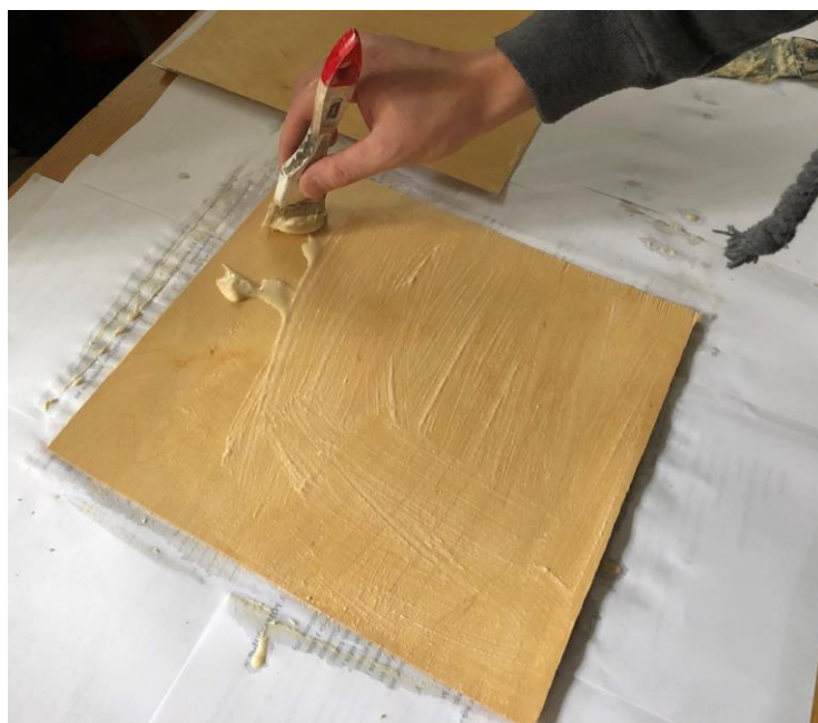
Рис. 2.1. Нанесення клею на поверхню шпону
