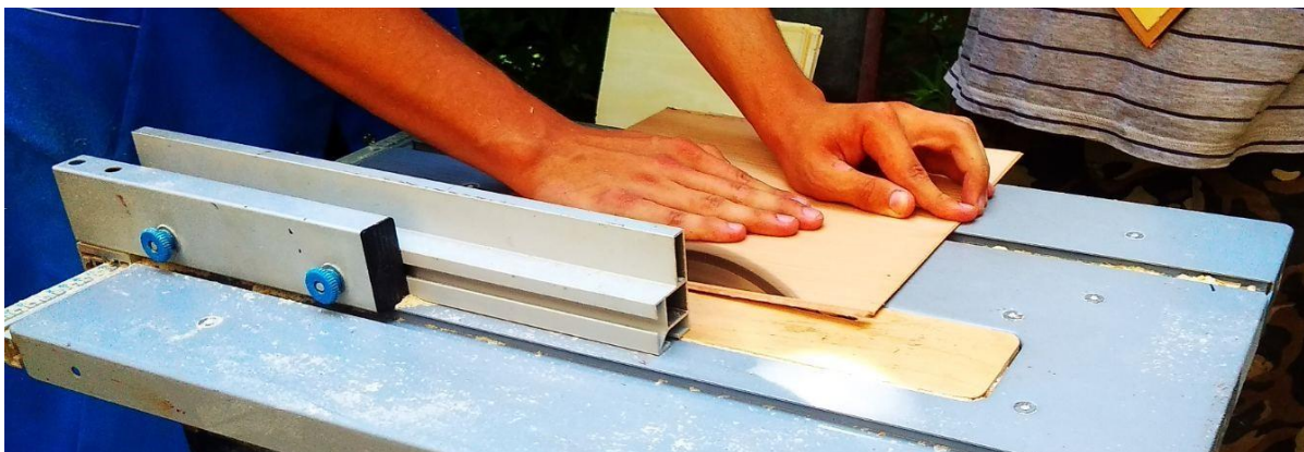
Рис. 2.3 - Робочий момент вирізання взірців фанери для випробування на фізико-механічні властивості
