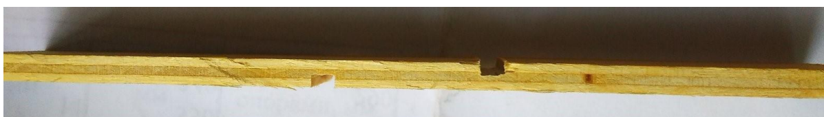
Рис. 2.4. Зразок для випробувань міцності фанери на зріз згідно EN 314-1.
