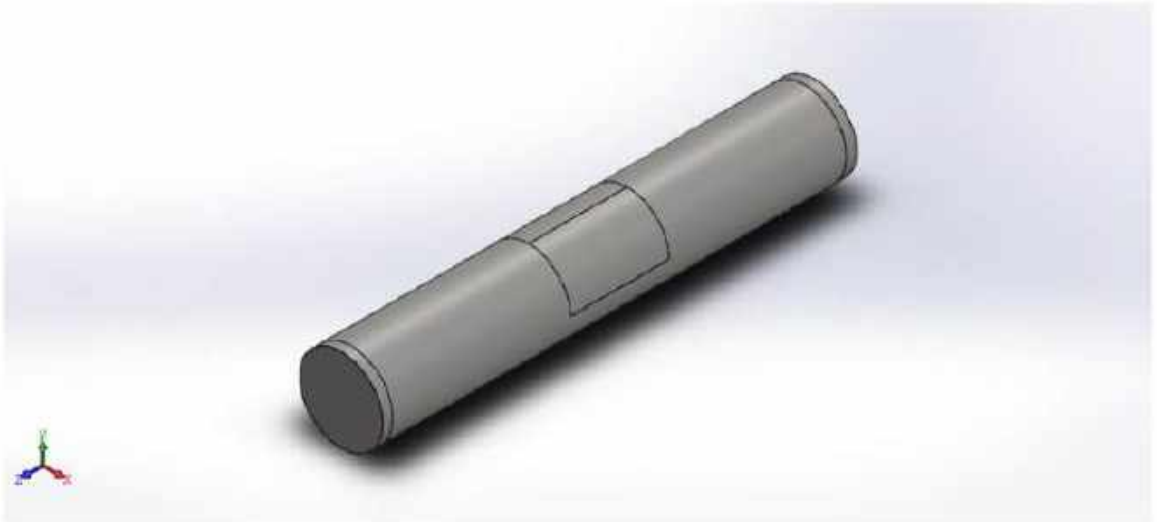
Рисунок 3.1 – Просторова модель рухомої осі поліспасти
