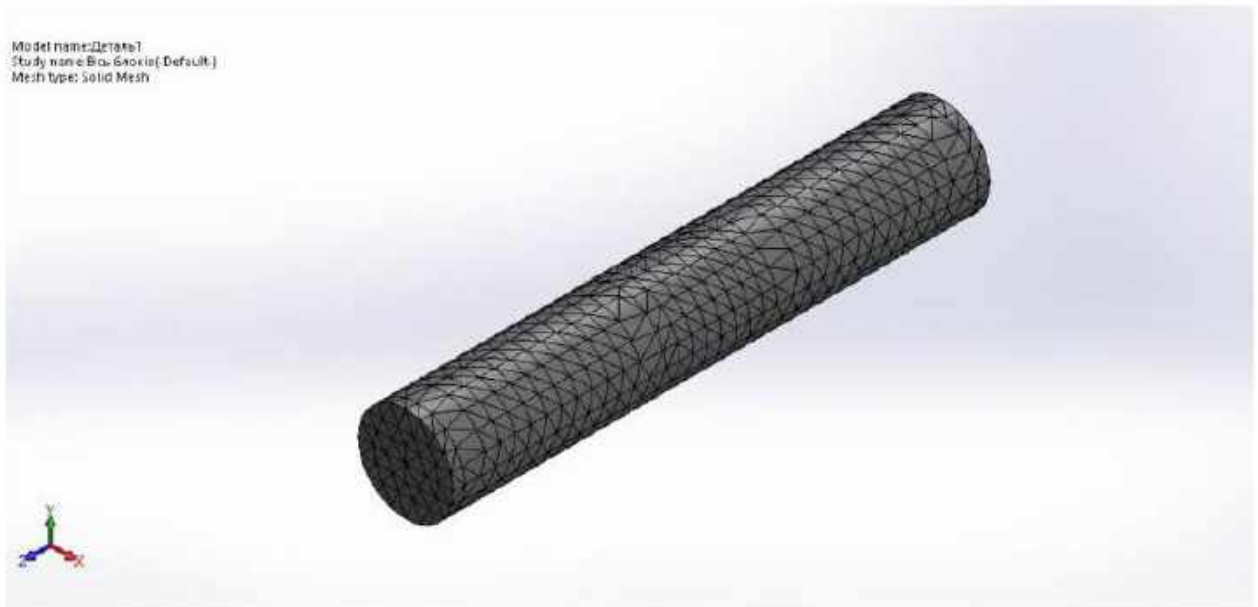
Рисунок 3.3 – Згенерована сітка напружень на поверхні рухомої осі
