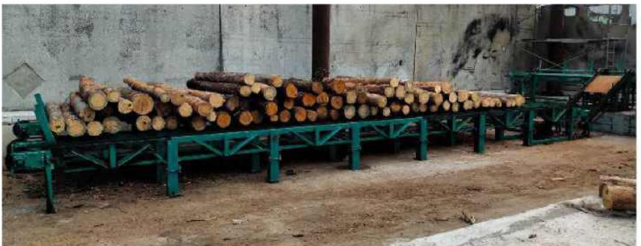
Рисунок 2.2 – Нагромаджувач лісоматеріалів із системою їх видачі до лісопильної рами фірми «Ясень»
