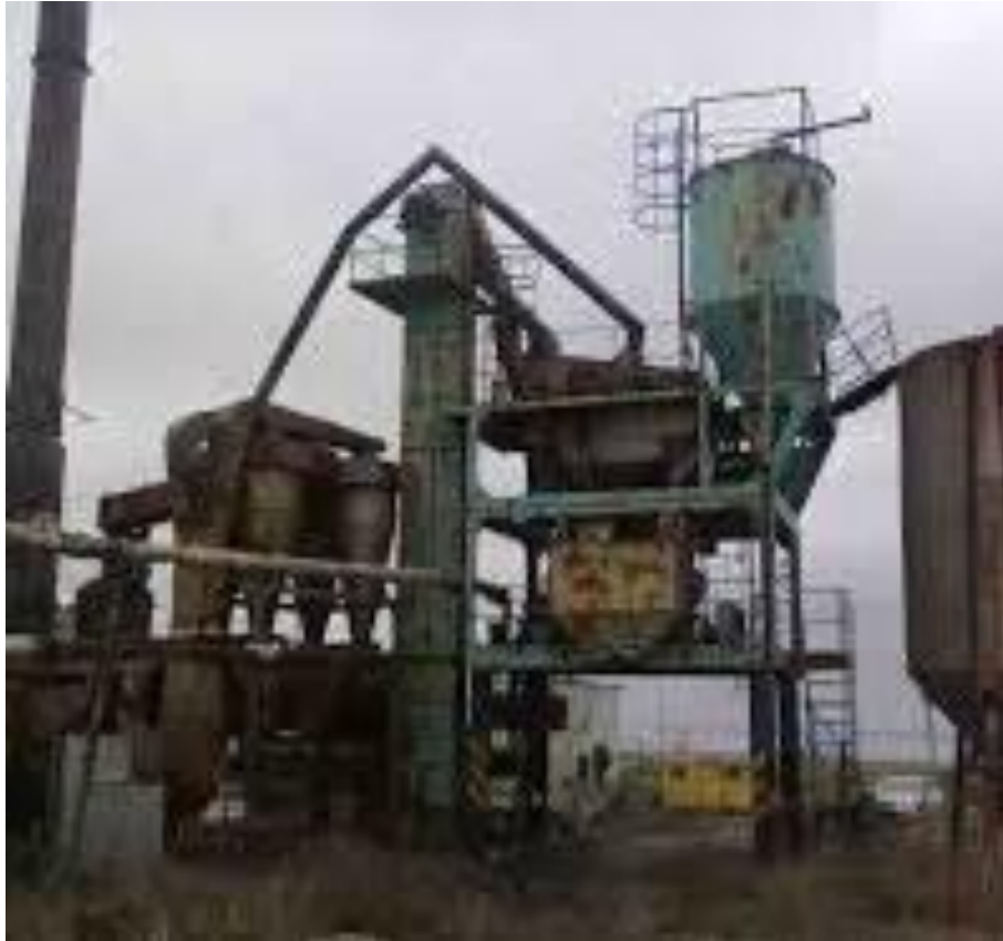
Рис. 1.2. Асфальтозмішувальна установка ДС-117-2Е
