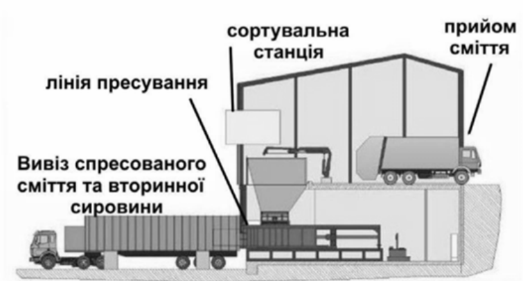
Рис. 5.2. Типова схема проміжної сміттеперевантажувальної станції [26]
