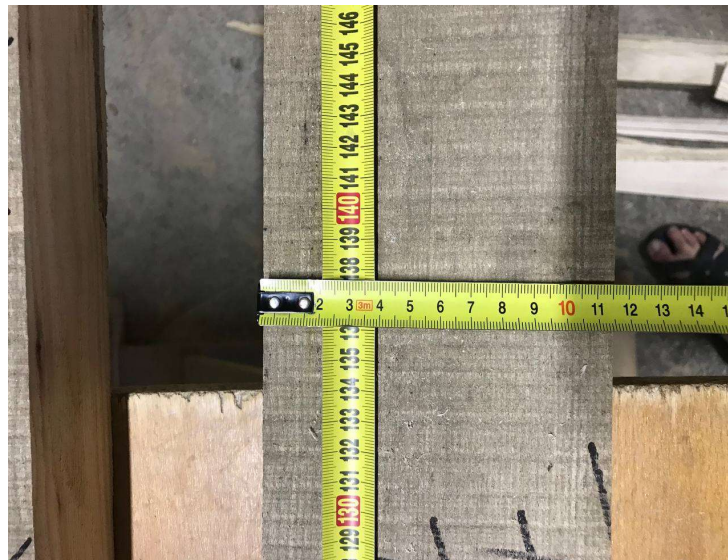
Рис. 2.7 Вершинна частина вимірювання ширини заготовки
