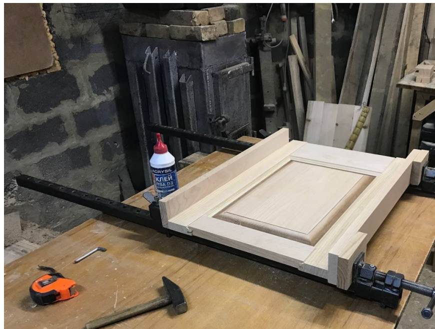
Рис. 1.17 Процес склеювання рамко-тахлевої конструкції у ваймах
