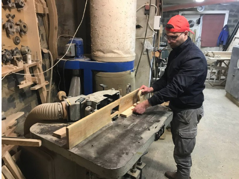
Рис. 1.14 Процес фрезерування провущини
