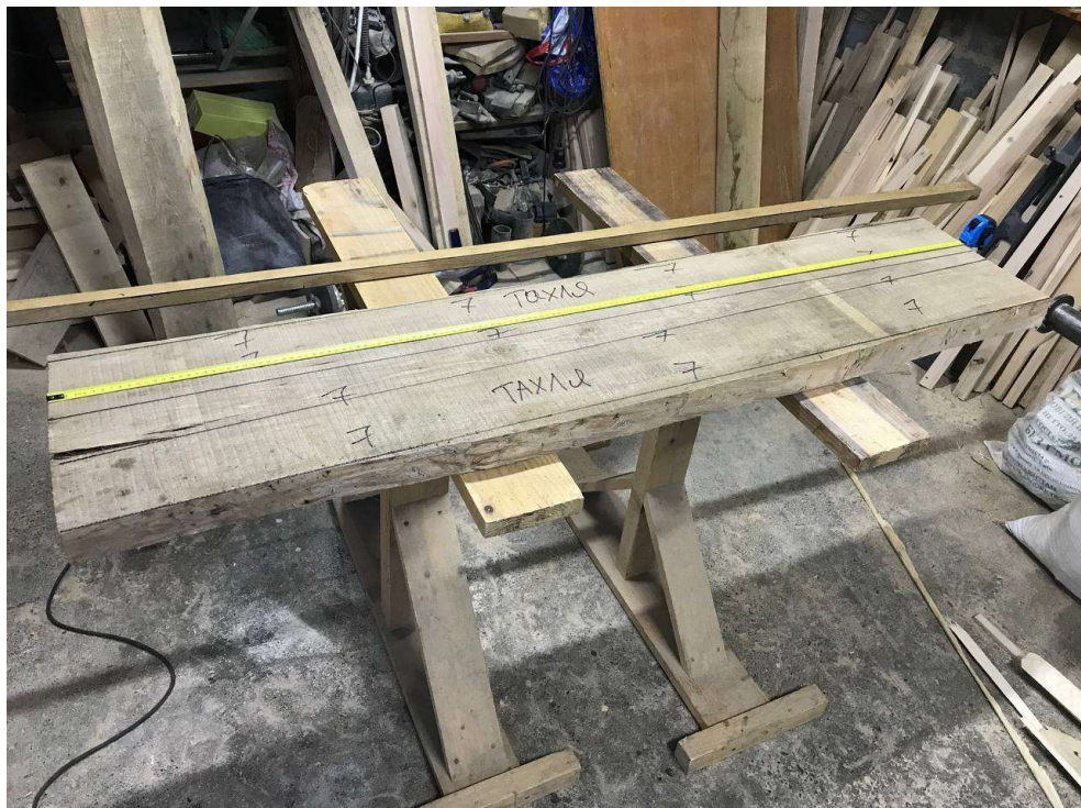
Рис 2.2 Вимірювання довжини пиломатеріалів
