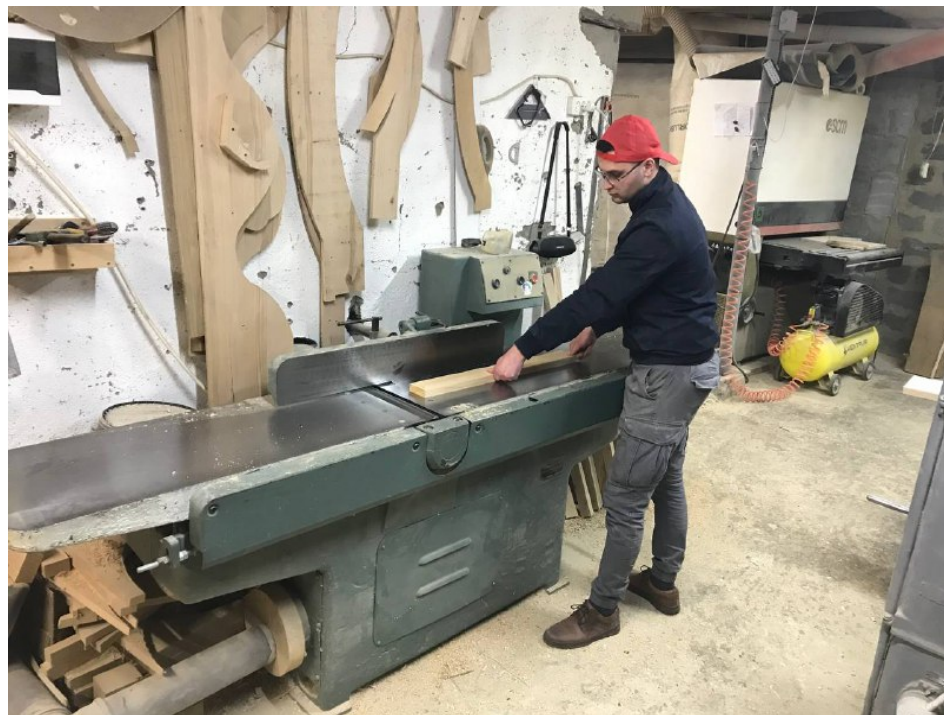
Рис. 1.7 Процес виставляння притисної лінійки та фугування
