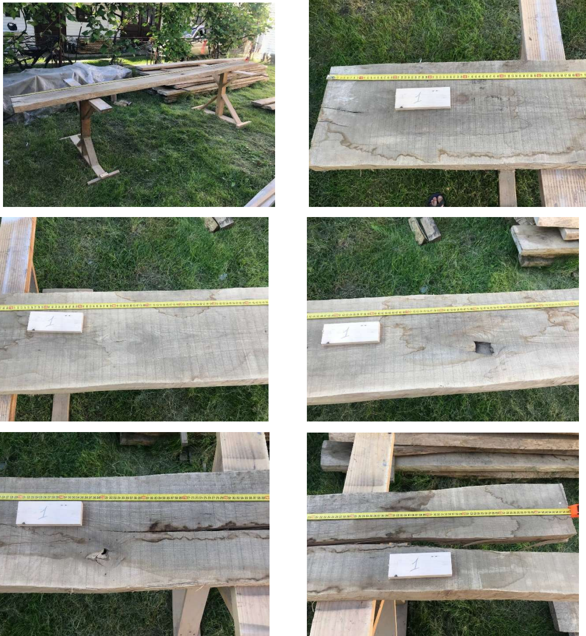
Рис.2.1. Заміри дошки та фіксування вад деревини на прикладі дошки №1
