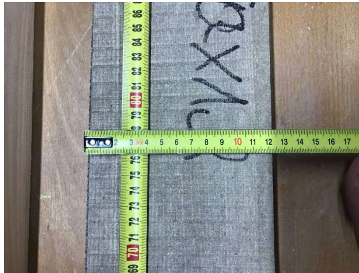
Рис. 2.6 Вимірювання ширини посередині довжини заготовки
