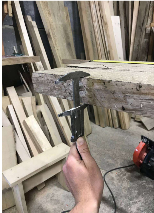
Рис 2.4 Вимірювання товщини пиломатеріалів
