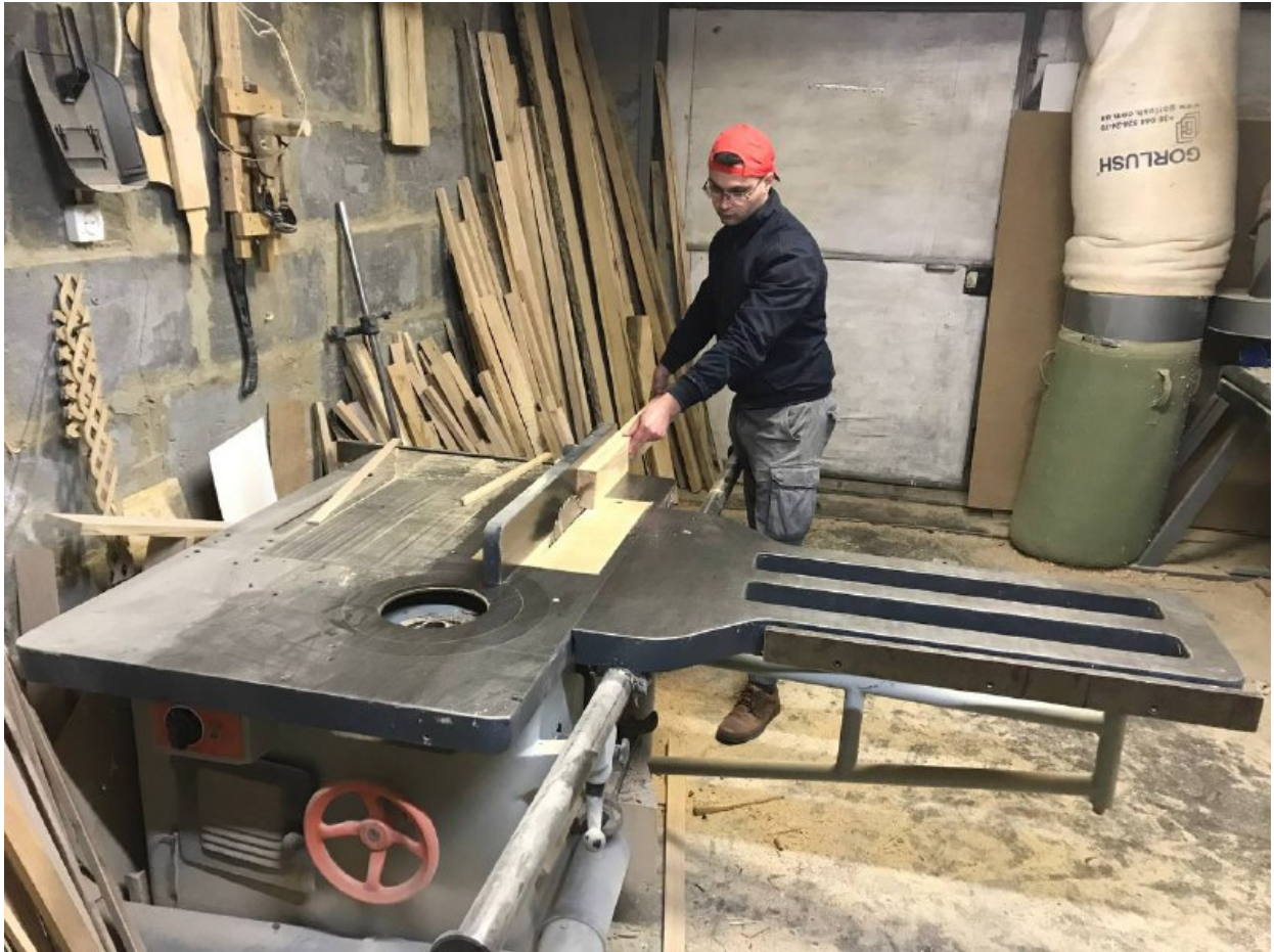
Рис. 1.8 Процес розкрою за товщиною
