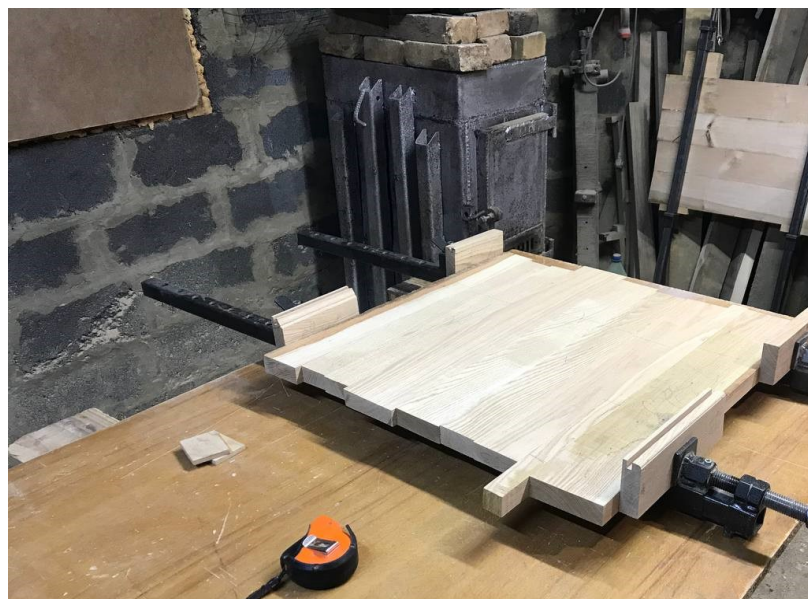
Рис. 1.16 Процес склеювання меблевого щита за допомогою вайм
