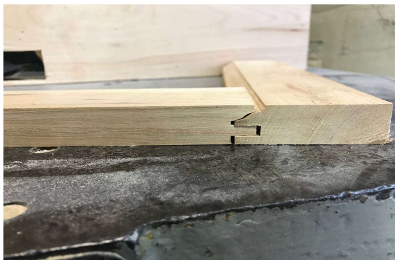
Рис 1.15 З'єднання рамки після фрезерування комплектом фрез для шипа та провущини
