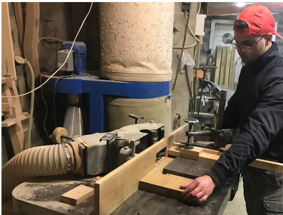
Рис. 1.13 Процес фрезерування шипа
