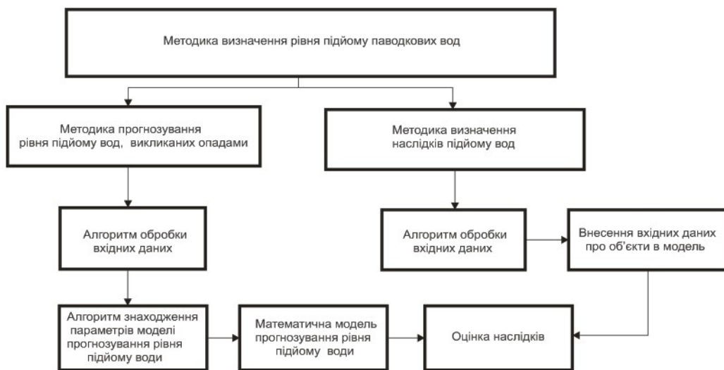
Рис. 3.1. Методика визначення рівня підйому води у водному об'єкті.
