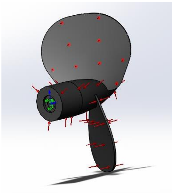
Рис. 3.19 – Кріплення та дія тиску на гвинт
