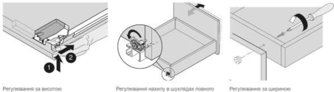
Рис. 11. Схема регулювання Тандем. Кріплення на замки
