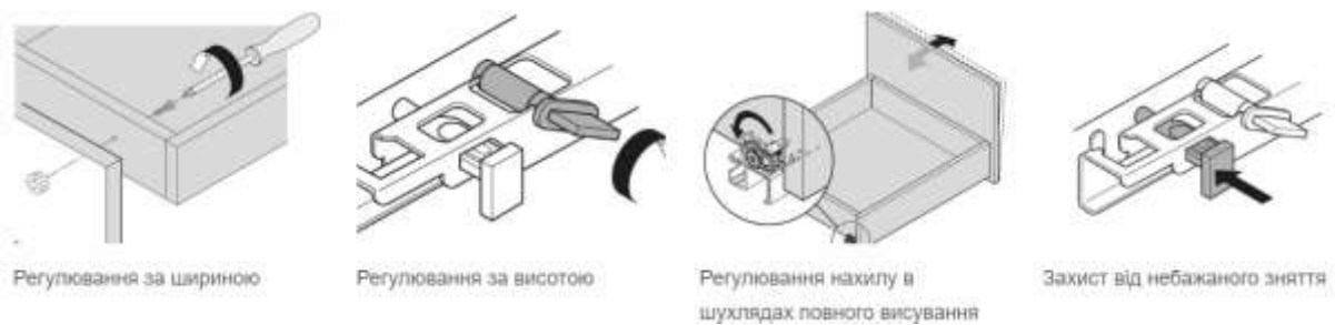
Рис. 12. Схема регулювання Тандем. Кріплення на фіксатори
