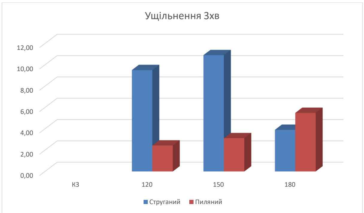
Рис 3.1.3 Залежність величини спресування від температури та при сталому часі ущільнення шпону
