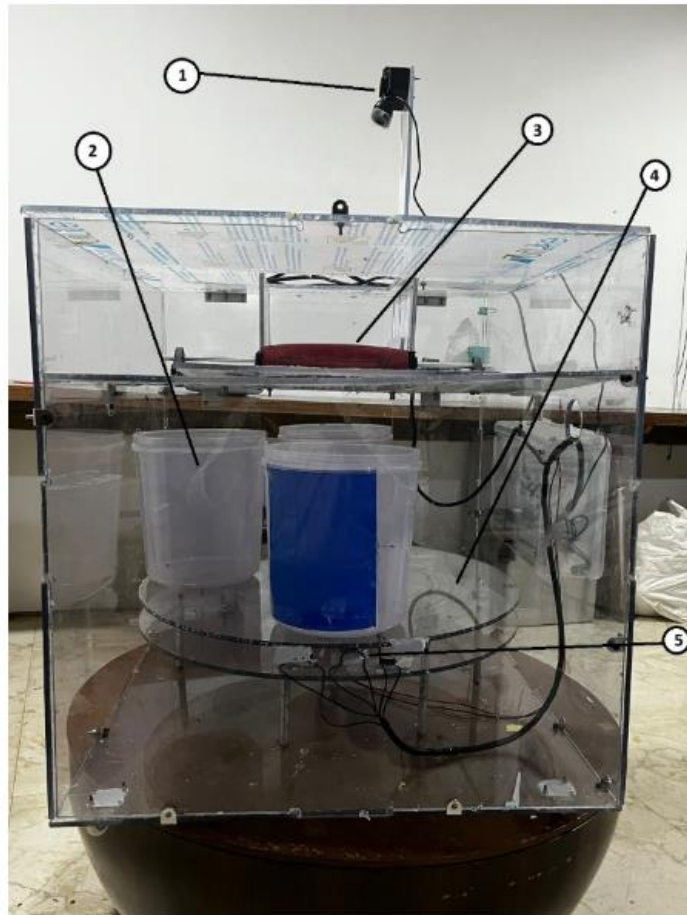
Рисунок 1.2 – Прототип розумного сміттового бака: камера 1, баки для відходів 2, конвеєрна стрічка 3, механізм обертового диска 4, кінцеві вимикачі 5.
