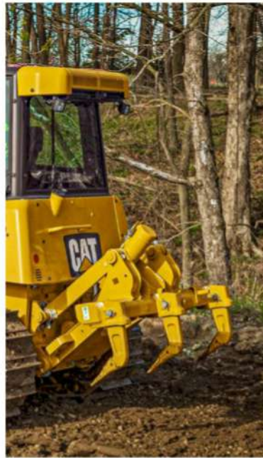
Рисунок 2.4 – Спеціалізована навісне обладнання на Caterpillar D6К для розпушення місцевого ґрунту
