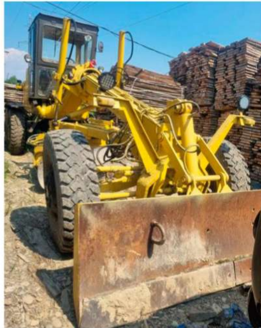
Рисунок 2.5 – Спеціалізований автогрейдер ДЗ 122 для поетапного планування й профілювання основи дорожнього полотна із місцевих ґрунтів
