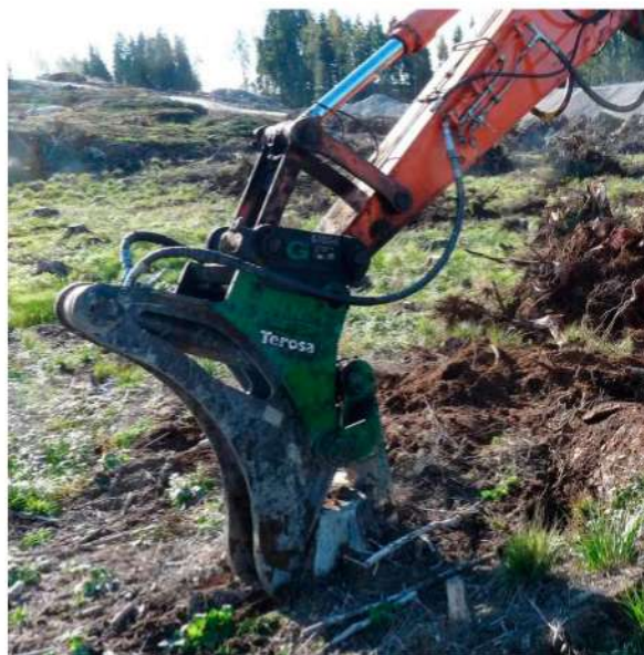
Рисунок 2.2 – Спеціалізована екскаваторно-корчувальна техніка для розкорчовки пнів дерев
