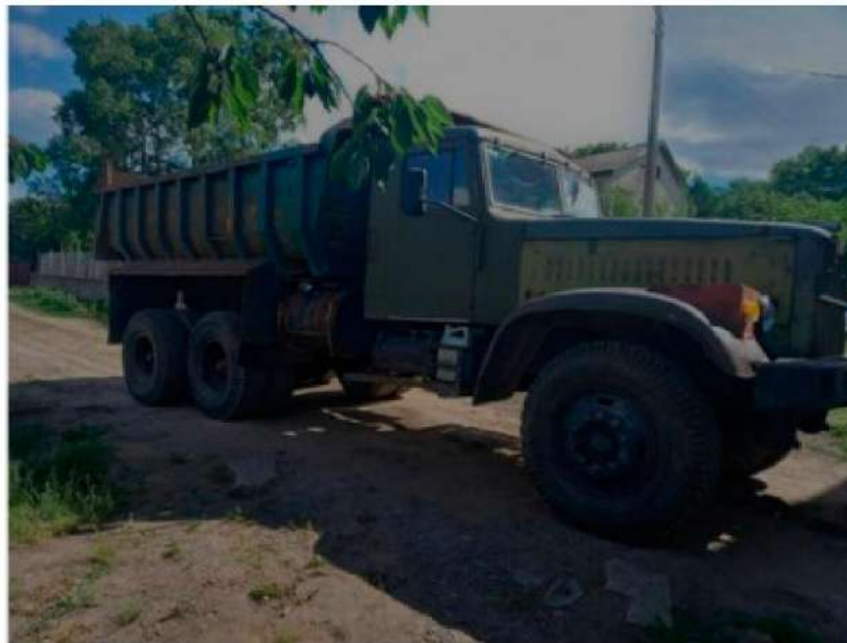
Рисунок 2.6 – Автомобіль-самоскид марки КраЗ-256Б1 для перевезення сипучих вантажів з кар'єру на площадку будівництва
