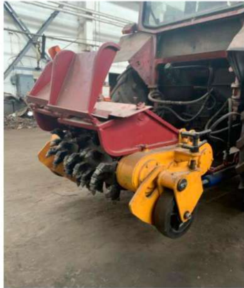
Рисунок 3.1 – Фреза дорожня горизонтальна ФРБ-9901 для розпушування шару земляного полотна вуса лісопромислового призначення
