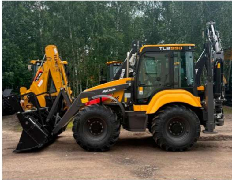
Рисунок 2.7 – Екскаватор-навантажувач з рівновеликими колесами (виробництва Туреччини)
