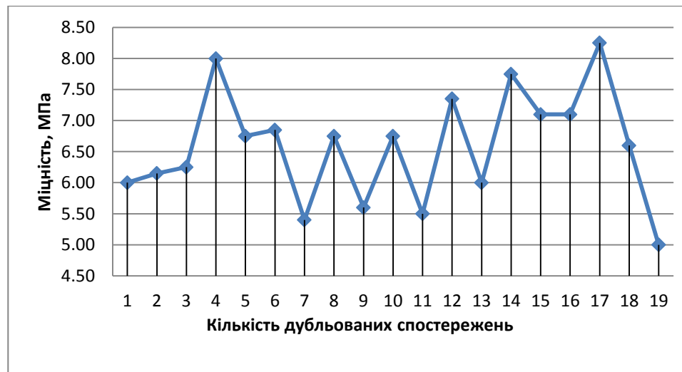
Рис. 4.3. Зміна міцності клейових з'єднань після шести місяців випробувань у природних умовах.
