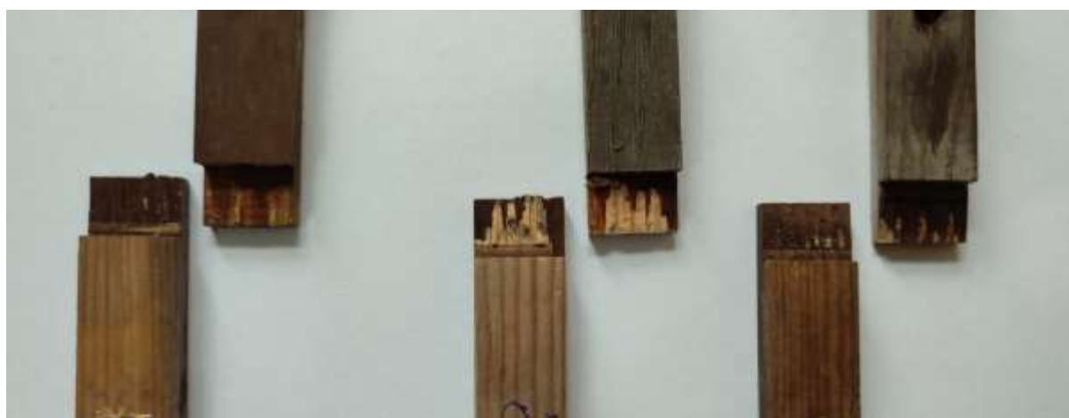
Рис. 4.23. Характер руйнування клейових з'єднань після двадцяти одного місяця випробувань за w_{\max} 88%, w_{\min} 47% та t_{\max} 28°C, t_{\min} 9.
