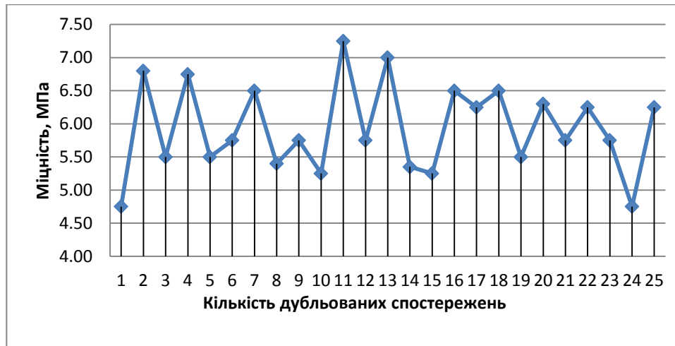
Рис. 4.7. Зміна міцності клейових з'єднань після вісімнадцяти місяців випробувань у природних умовах.
