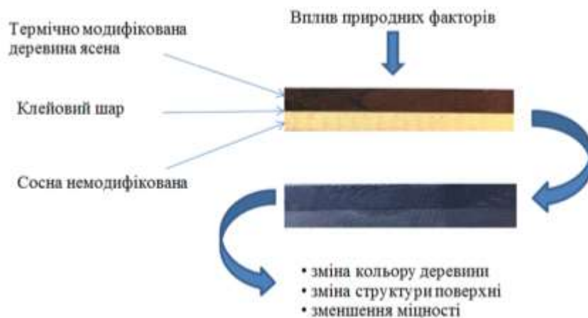
Рис. 2.4. Вплив навколишнього середовища на зміну властивостей клейових з'єднань.
