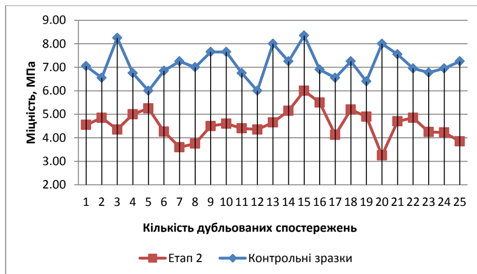
Рис. 4.11. Зміна міцності після другого етапу випробувань.
