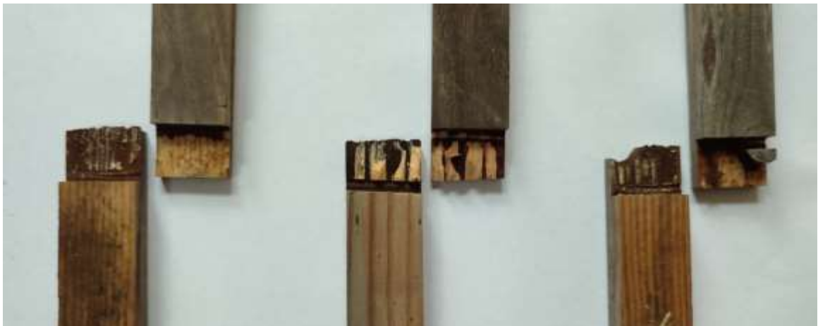
Рис. 4.20. Характер руйнування клейових з'єднань після дванадцяти місяців випробувань.
