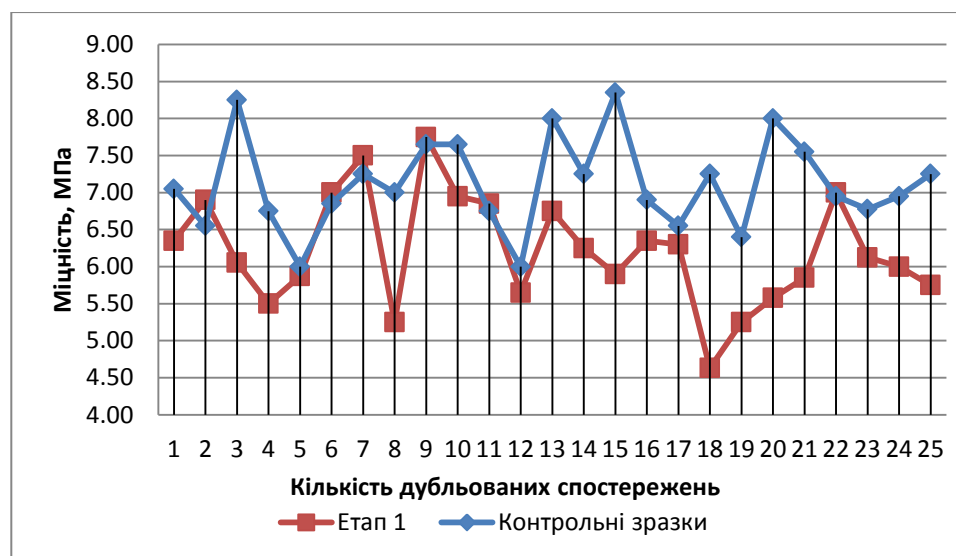
Рис. 4.10. Зміна міцності після першого етапу випробувань.
