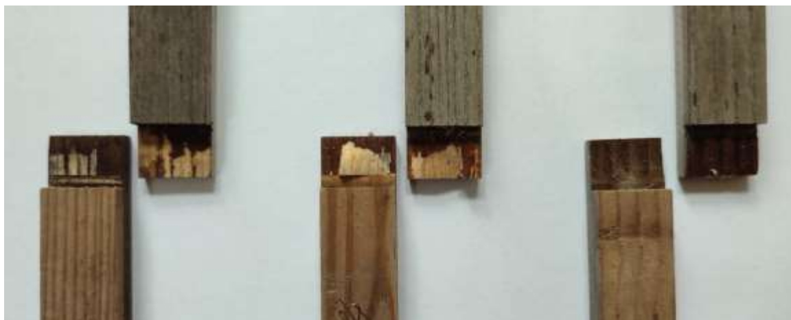
Рис. 4.21. Характер руйнування клейових з'єднань після п'ятнадцяти місяців випробувань за w_{\max} 94%, w_{\min} 57% та t_{\max} 7°C, t_{\min} -15.
