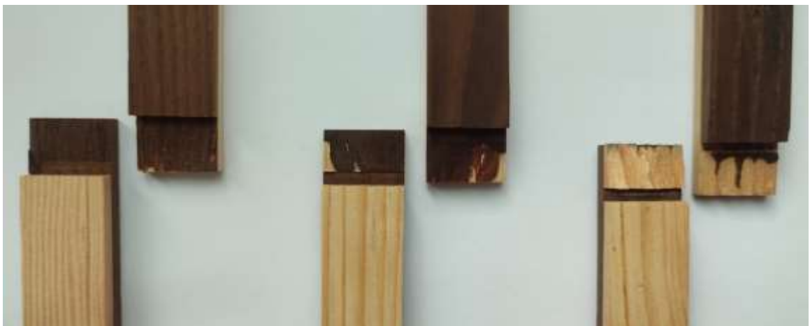
Рис. 4.16. Характер руйнування контрольних зразків.
