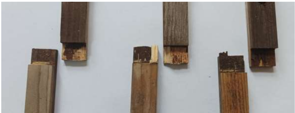
Рис. 4.19. Характер руйнування клейових з'єднань після дев'яти місяців випробувань.
