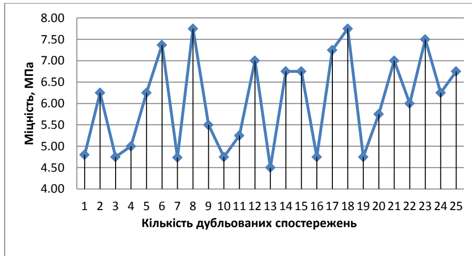
Рис. 4.4. Зміна міцності клейових з'єднань після дев'яти місяців випробувань у природних умовах.
