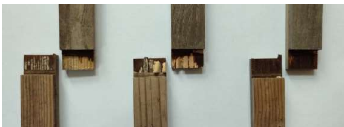
Рис. 4.22. Характер руйнування клейових з'єднань після вісімнадцяти місяців випробувань за w_{\max} 92%, w_{\min} 34% та t_{\max} 12°C, t_{\min} -11.
