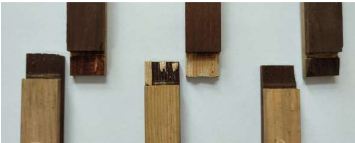
Рис. 4.26. Характер руйнування клейових з'єднань після другого етапу випробувань.
