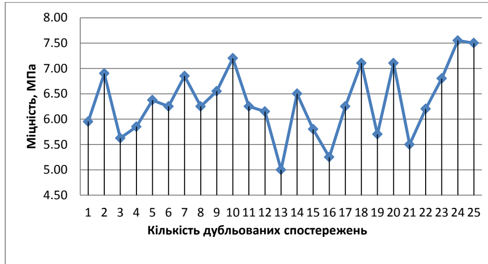
Рис. 4.2. Зміна міцності клейових з'єднань після трьох місяців випробувань у природних умовах.
