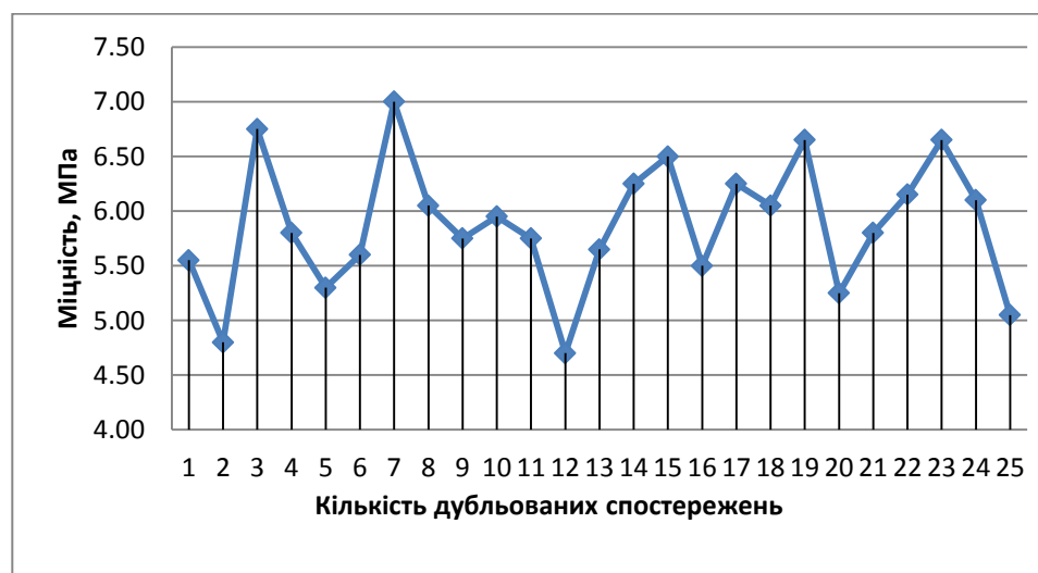
Рис. 4.6. Зміна міцності клейових з'єднань після п'ятнадцяти місяців випробувань у природних умовах.
