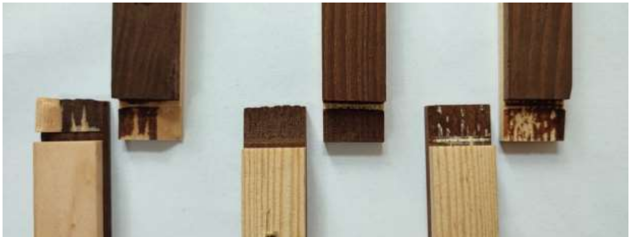
Рис. 4.25. Характер руйнування клейових з'єднань після першого етапу випробувань.
