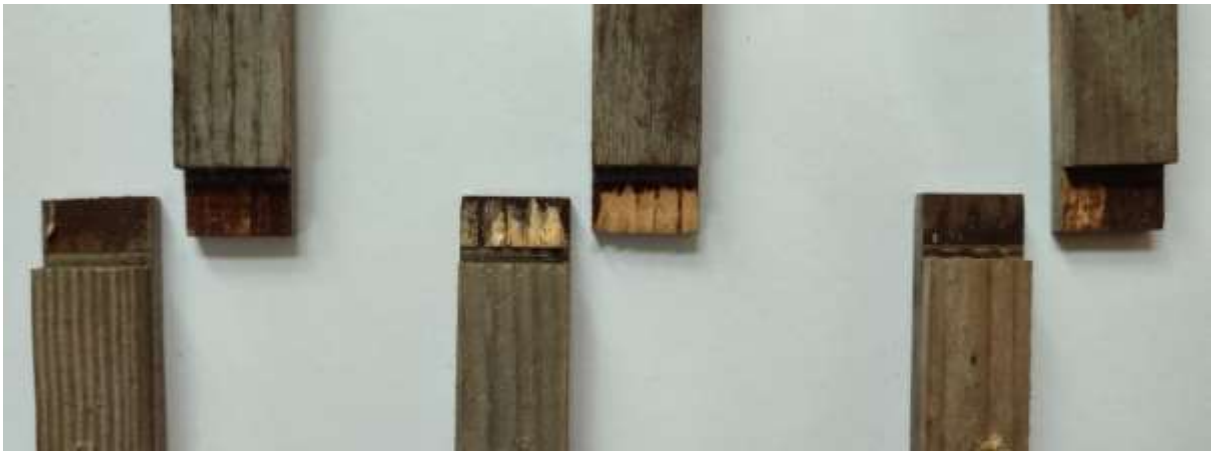
Рис. 4.24. Характер руйнування клейових з'єднань після двадцяти чотирьох місяців випробувань за w_{\max} 94%, w_{\min} 48% та t_{\max} 23°C, t_{\min} 3.
