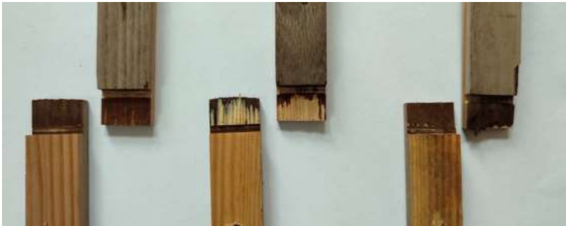
Рис. 4.18. Характер руйнування клейових з'єднань після шести місяців випробувань.
