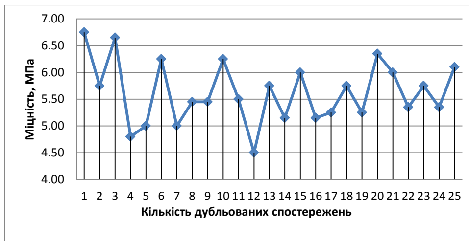
Рис. 4.8. Зміна міцності клейових з'єднань після двадцяти одного місяця випробувань у природних умовах.
