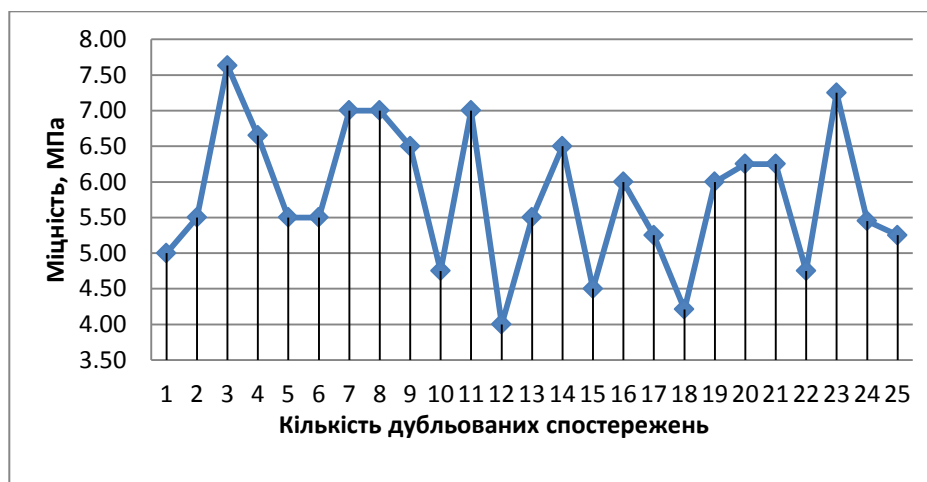
Рис. 4.5. Зміна міцності клейових з'єднань після дванадцяти місяців випробувань у природних умовах.
