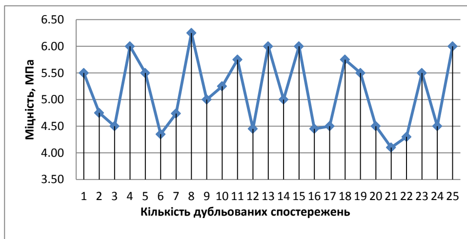
Рис. 4.9. Зміна міцності клейових з'єднань після двадцяти чотирьох місяців випробувань у природних умовах.
