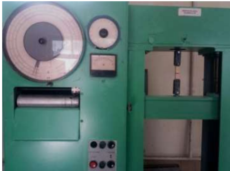
Рис. 3.6. Розривна машина для випробування зразків марки Р-05.
