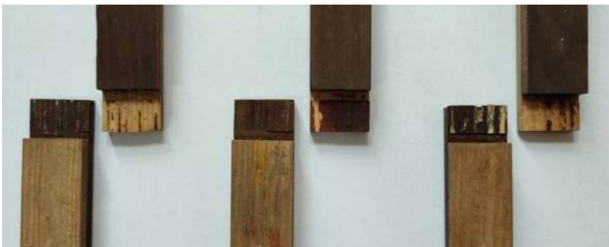
Рис. 4.27. Характер руйнування клейових з'єднань після третього етапу випробувань.
