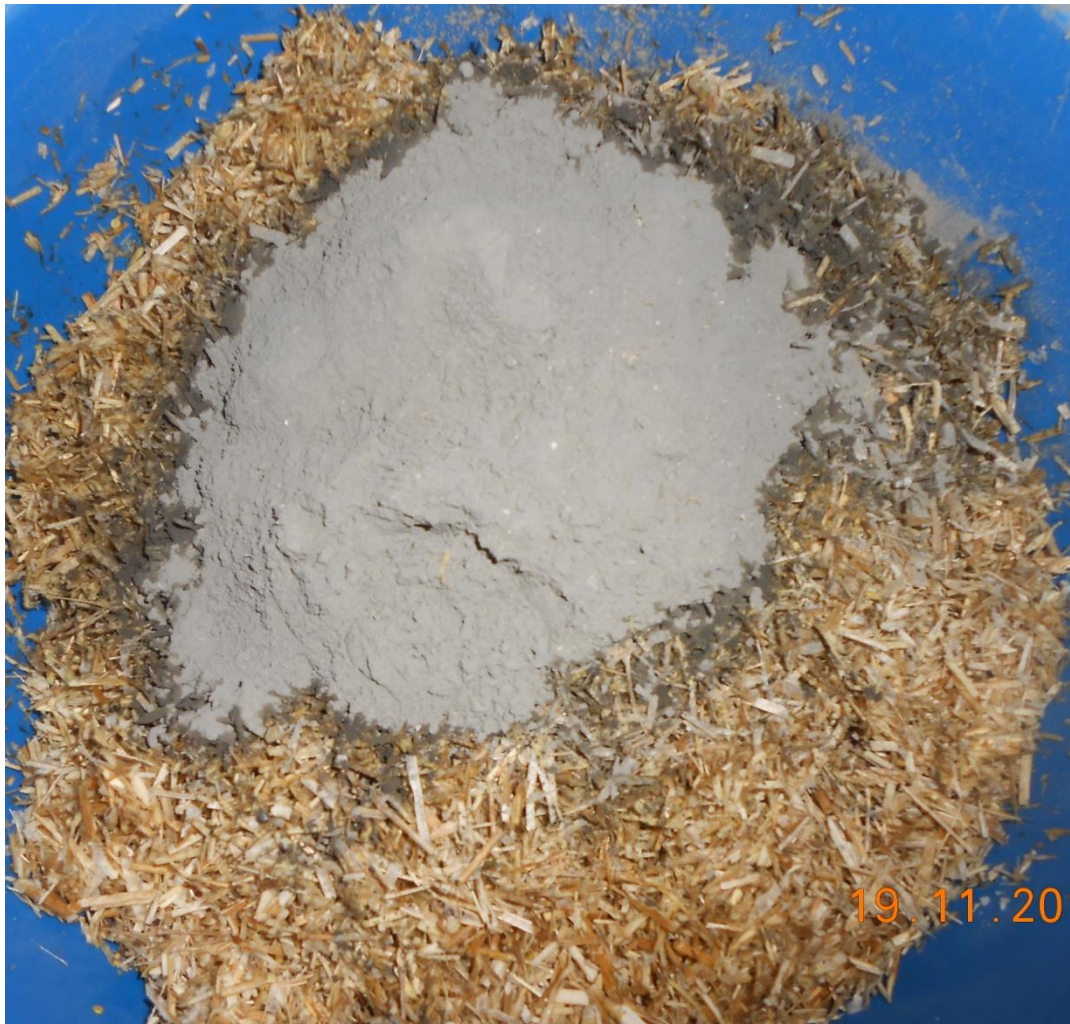
Рис.2.3. Змішування компонентів для отримання арболітової суміші
