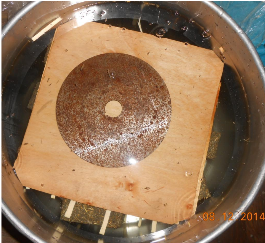
Рис.2.8.Робочий момент проведення випробування на водопоглинання
