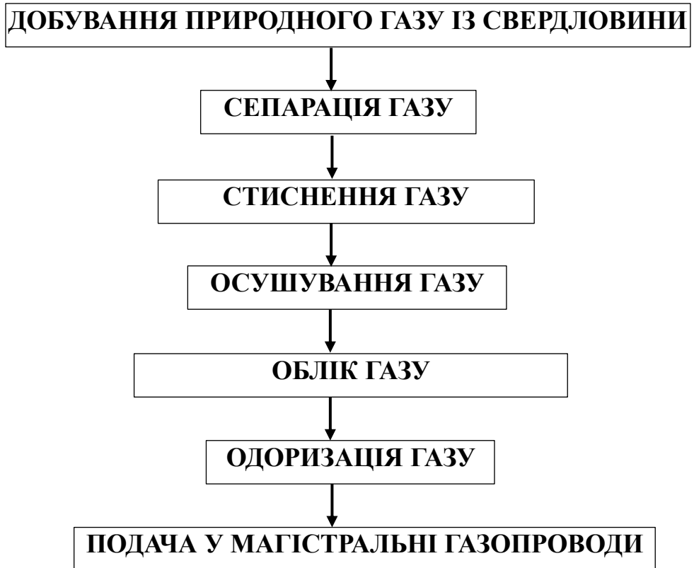
Рис. 12. Технологічна схема операцій щодо природного газу на УКПГ на підприємстві «Експерт Петролеум Україна»
