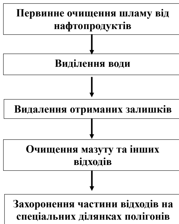
Рис. 10. Структурно-технологічна схема переробки нафтових шламів нафтогазової промисловості
