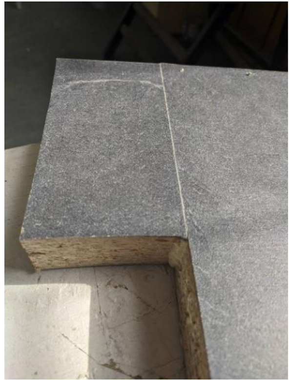
Рис 2.9. – Зразок склеєний клеєм ПУР 501
