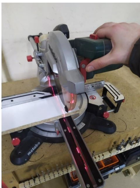
Рис. 2.6 Розкрій заготовок на зразки
