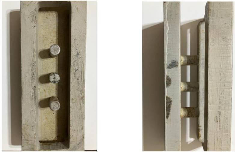
Рис. 3.4. Приспосіблення для визначення верхнього шару тришарової паркетної дошки.
