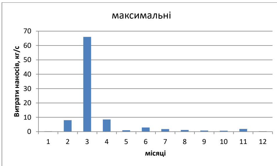
Рис. 4.3. Динаміка максимальних витрат завислих наносів по місяцях року у річці Жванчик на посту Ластівці за багатолітній період
