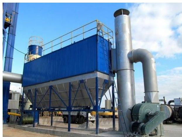
Рис. 4.1.1. Гравітаційний пиловловлювач з вертикальними перегородками
