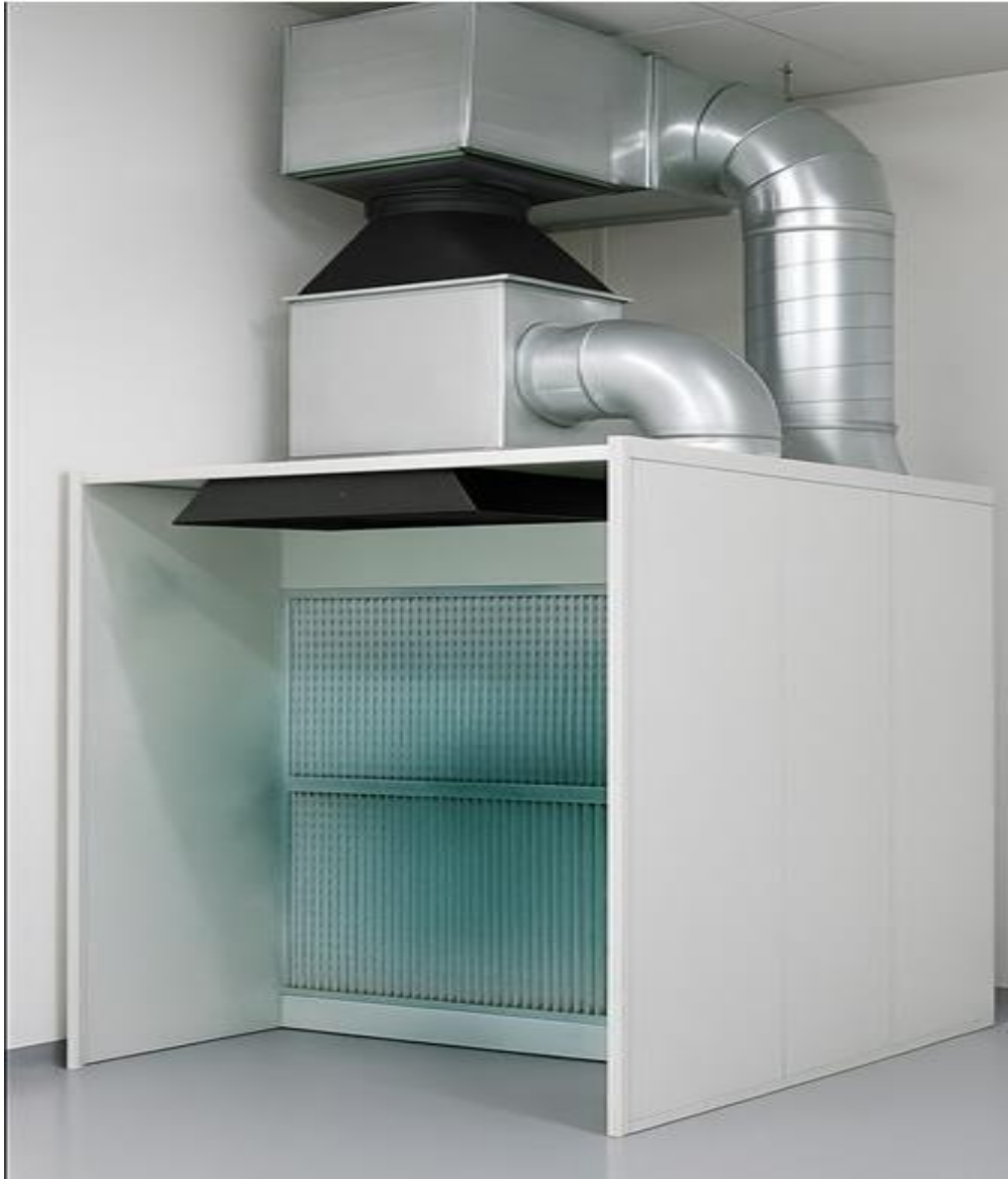
Рисунок 2.3 Фільтраційно-вентиляційний модуль лакофарбової камери
