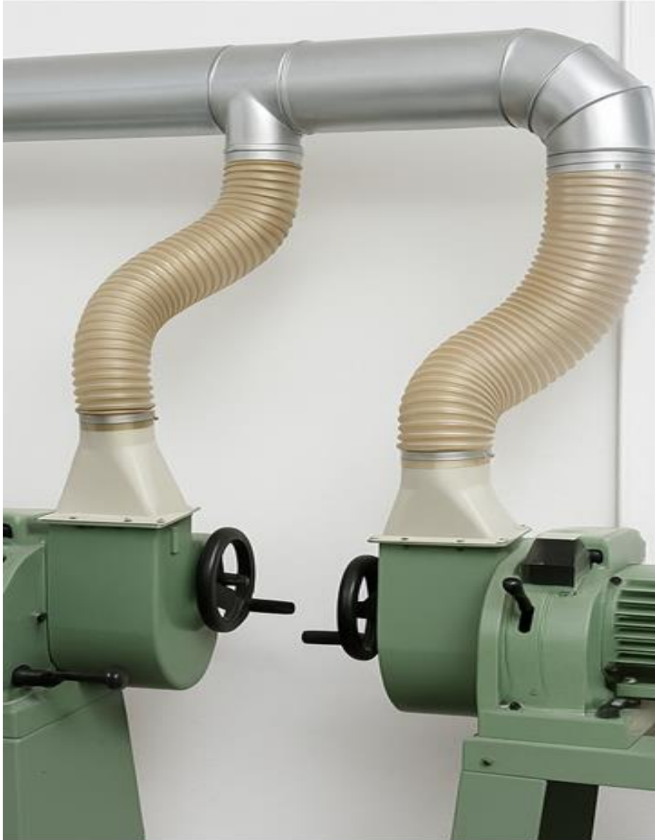
Рисунок 2.3 Локальні відсмоктувачі та аспіраційні патрубки на деревообробних верстатах
