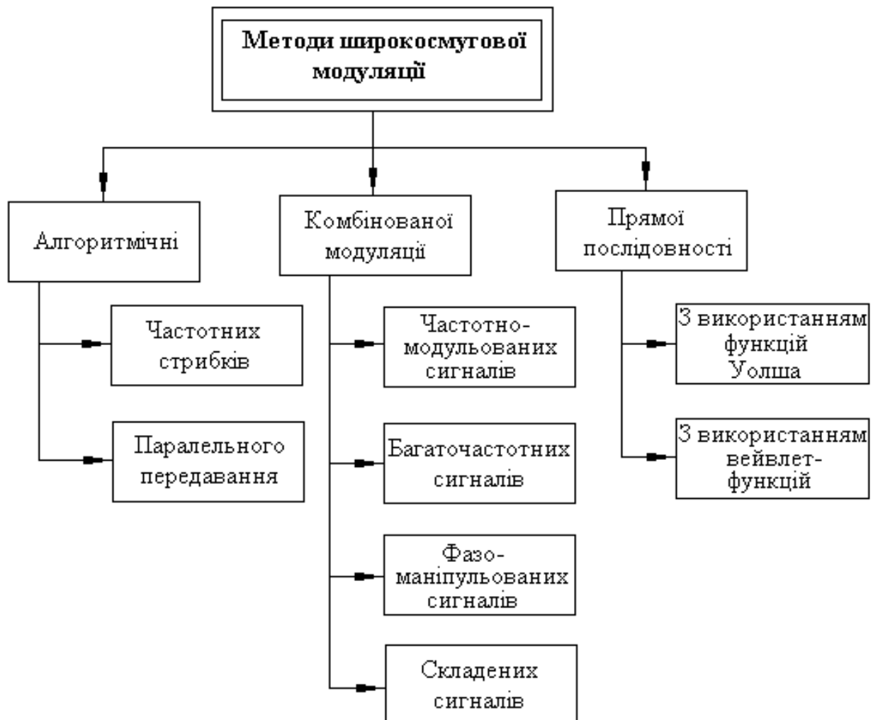
Рис. 2.3. Дерево методів синтезу широкопasmових завадостійких баркероподібних послідовностей
